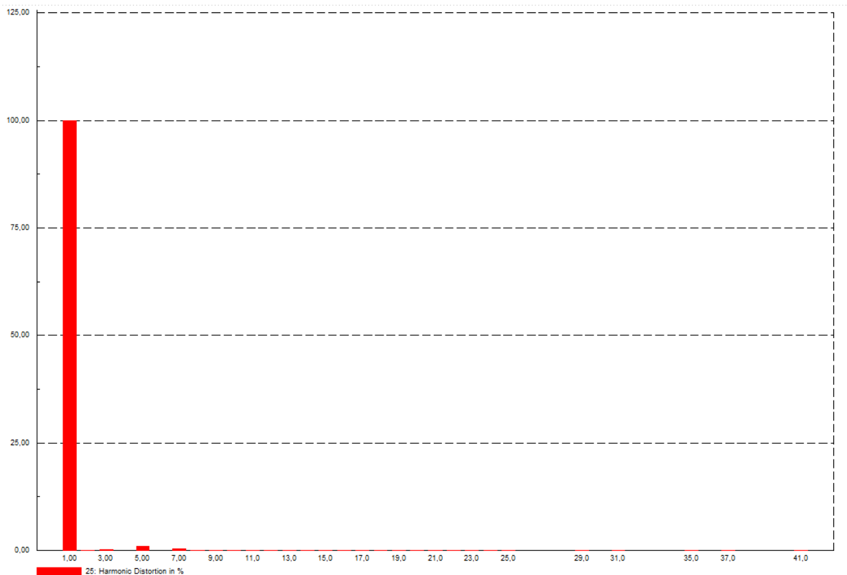
Slika 4.13.: Harmonijski spektar u postocima čvora 25 u mreži napajanoj konvencionalnim izvorima
