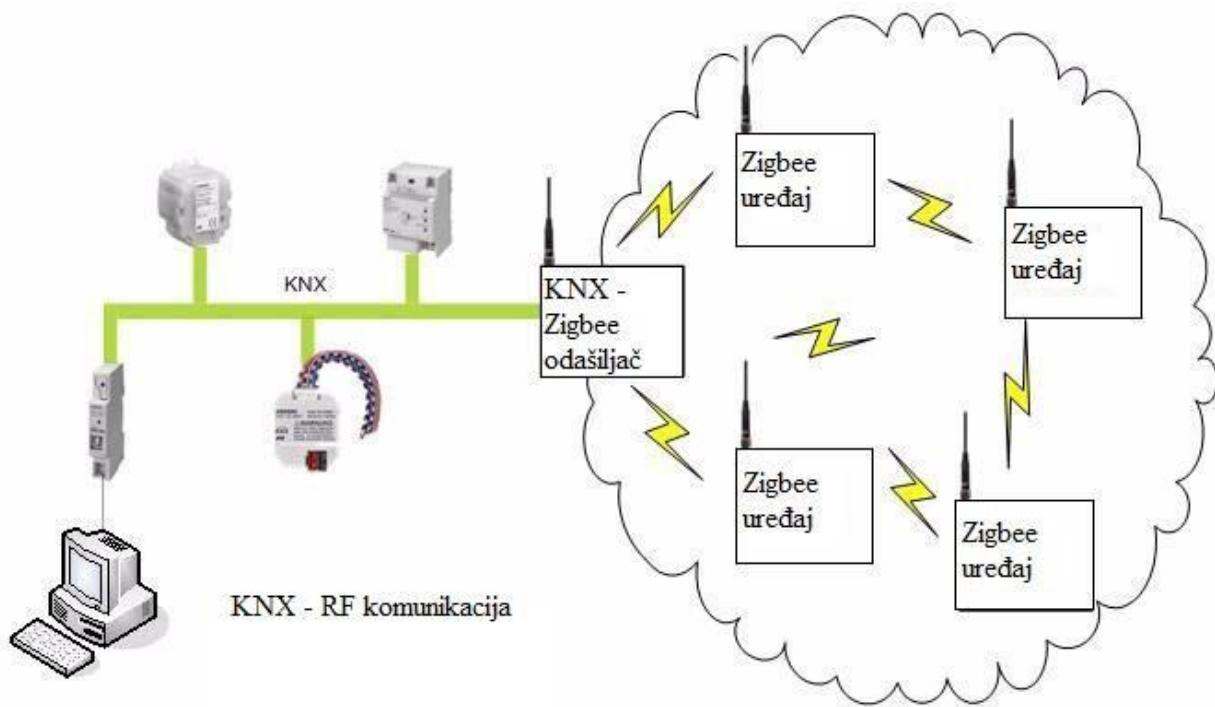
Slika 3.5 – KNX radio frekvencijski prijenos [12]
