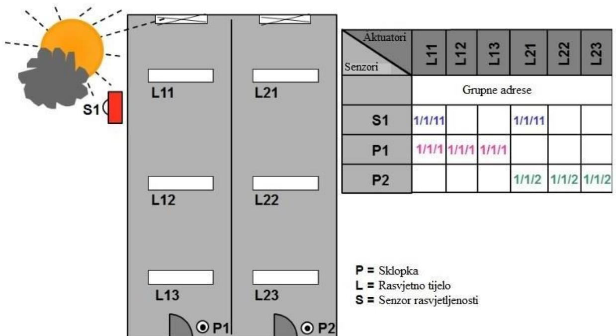
Slika 3.7 – Izgled nacrta adresiranih uređaja [14]
