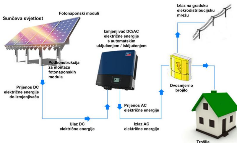
Slika 4.2. Mrežni fotonaponski sustav [17]
