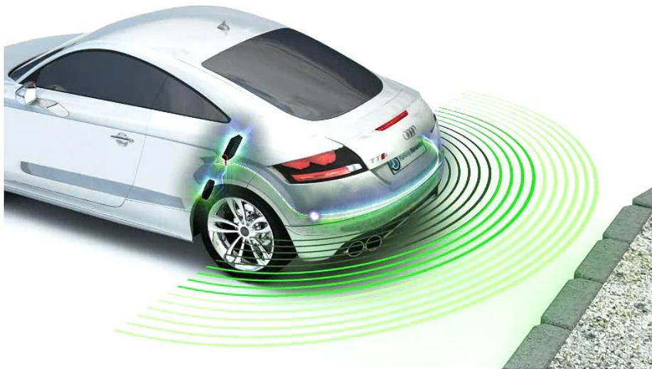
Slika 2.2. Elektromagnetski sustav parking senzora [5]
