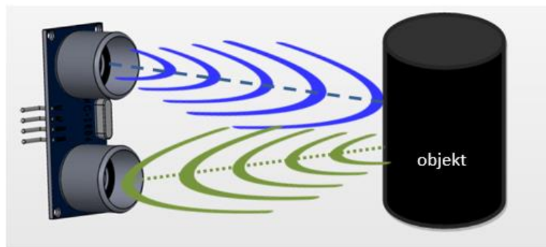
Slika 2.7. Rad ultrazvučnog senzora HC-SR04 [11]
