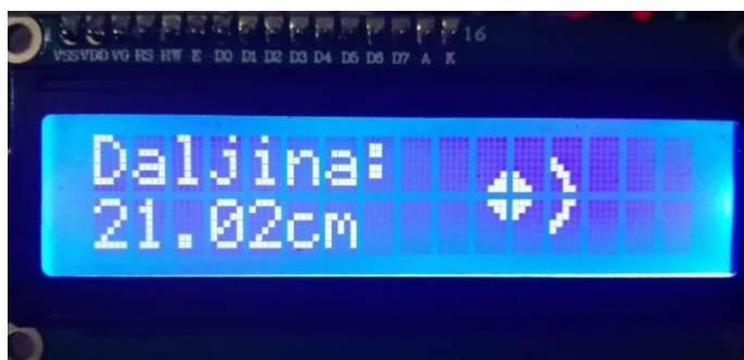
Slika 4.2. Izgled zaslona na udaljenosti od 21 cm
