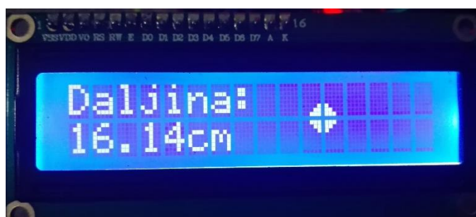
Slika 4.1. Izgled zaslona na udaljenosti od 16 cm
