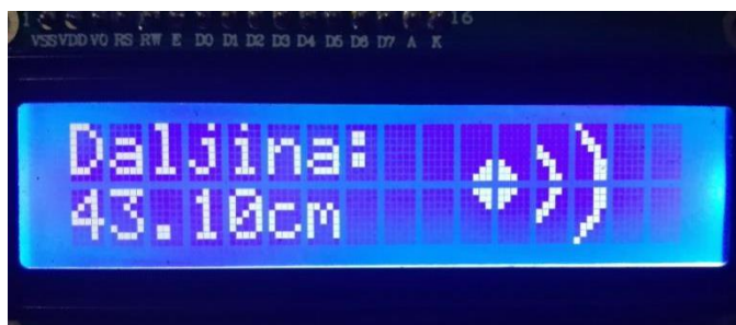
Slika 4.3. Izgled zaslona na udaljenosti od 43 cm
