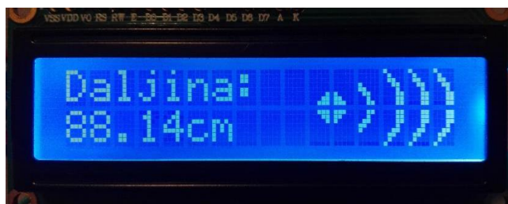
Slika 4.4. Izgled zaslona na udaljenosti od 88 cm
