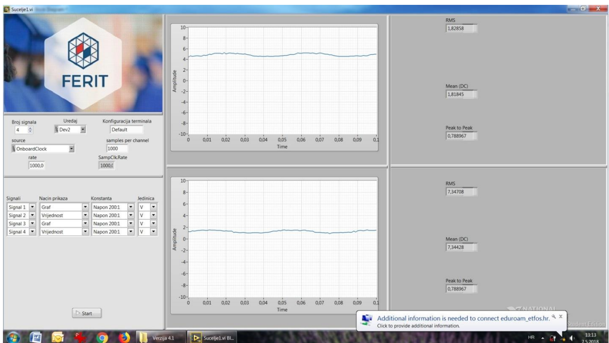
Sl. 3.53: Prikaz četiri signala s DAQ kartice (valni oblik/vrijednost).
