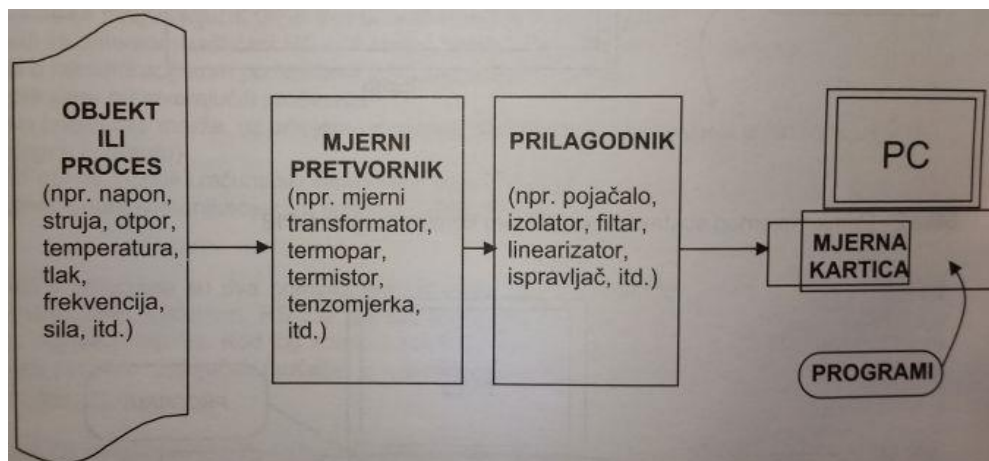
Sl. 2.16: Blok dijagram automatiziranog mjernog sustava.[1]
