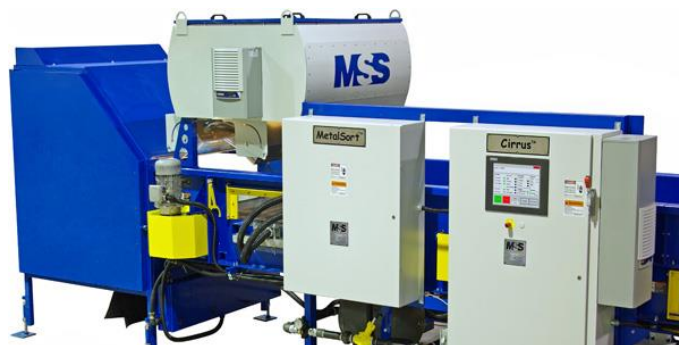
Sl. 3.5. Uređaj za optičko sortiranje tvrtke MSS
