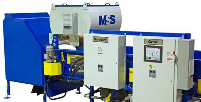
Sl. 3.5. Uređaj za optičko sortiranje tvrtke MSS
