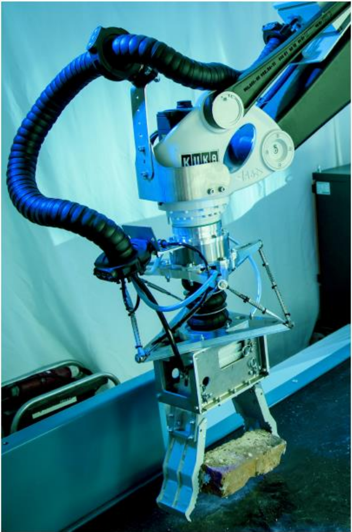
Sl. 4.9. Pneumatska hvataljka ZenRobotics Recycler-a
