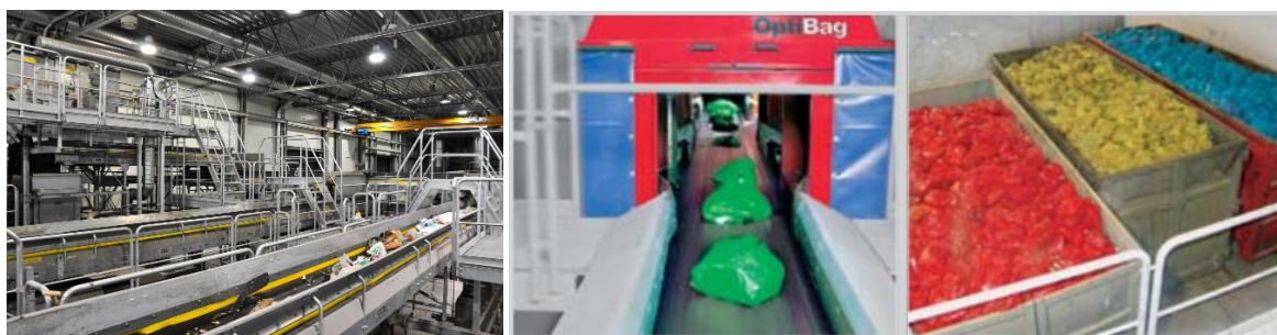
Sl. 4.28. Proces razvrstanja otpada OptiBag
