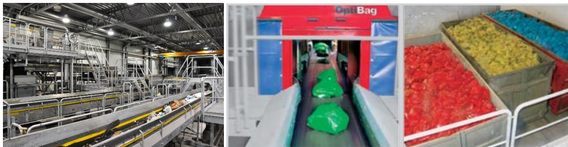
Sl. 4.28. Proces razvrstanja otpada OptiBag
