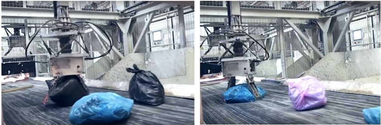
Sl. 4.6. Sortiranje plastičnih vrećica prema bojama uz pomoć ZenRobotics uređaja (ZRR 3)
