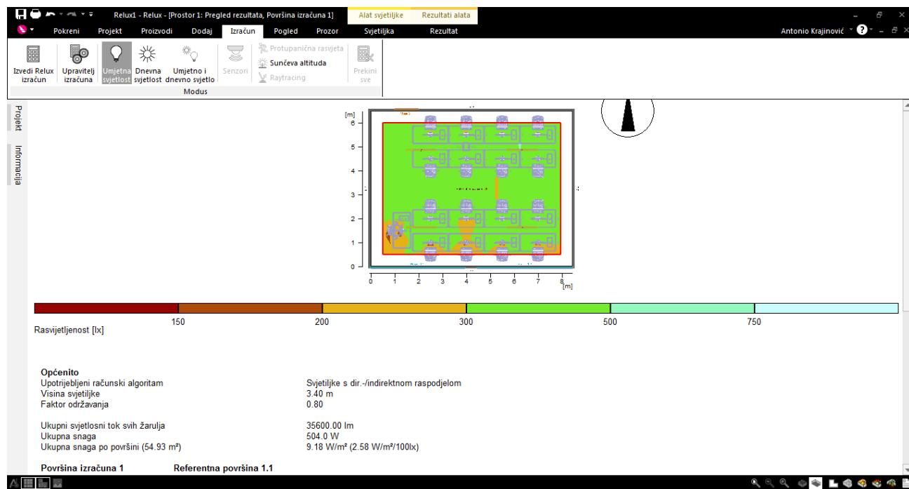
Slika 4.14. Rezultati svjetlotehničkog izračuna za unutrašnjost
