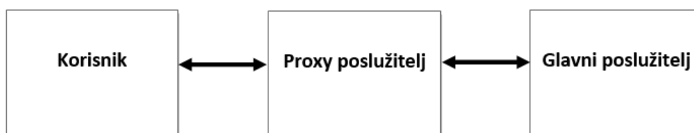
Sl. 3.4. Struktura klijent-poslužitelj s proxy poslužiteljem
