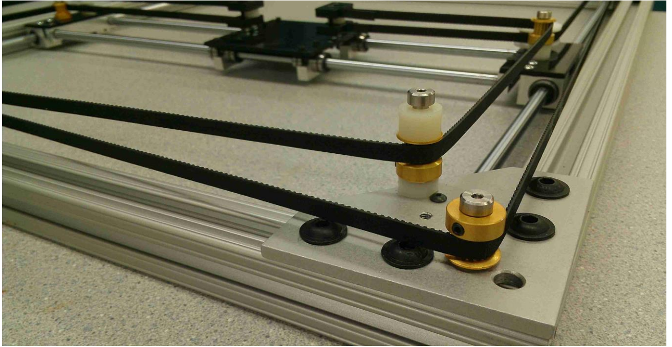
Slika 3.8.Kraj 2D pomičnog sustava 14
