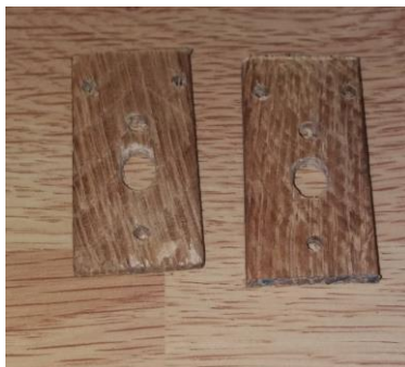
Sl. 3.6. Lamellice koje se postavljaju s vanjske strane kutije
