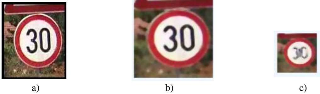
Slika 3.4. Usporedba originalne slike (a) i filtriranih slika veličina: 100x100 piksela (b), 50x50 piksela(c), uz veličinu prozora medijan filtra iznosa 5
