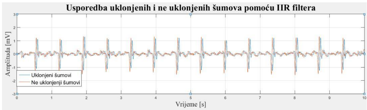
Sl.4.13. Usporedba uklonjenih i ne uklonjenih šumova pomoću IIR filtera
