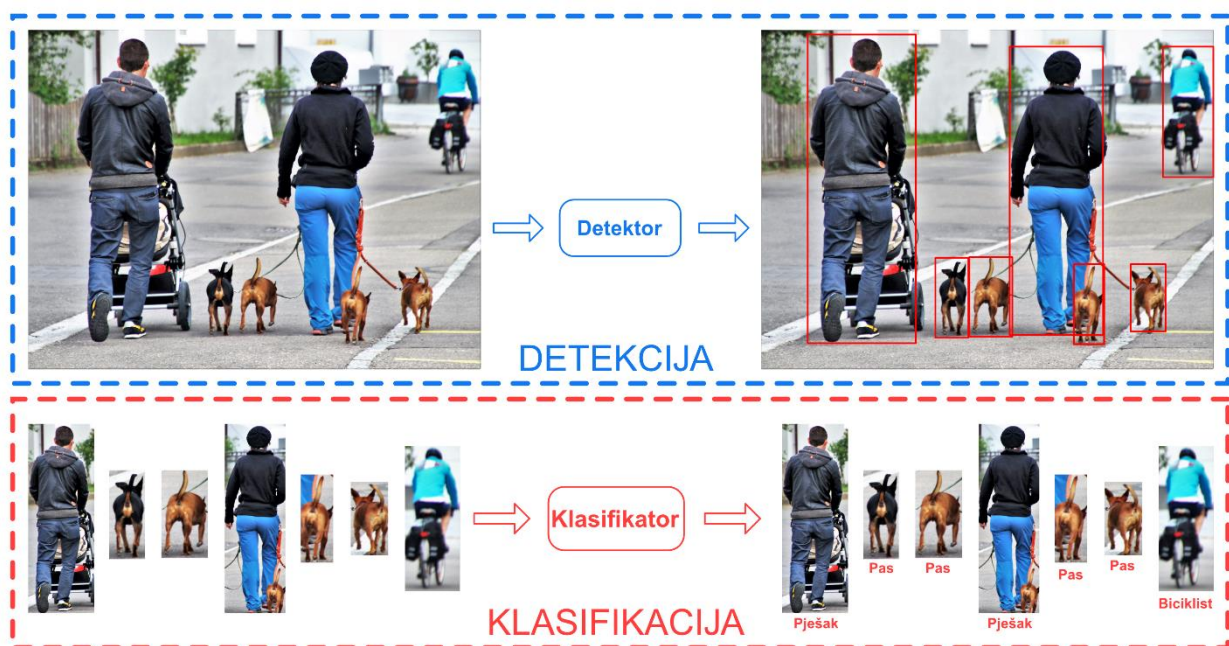
Slika 2.1. Tok algoritama detekcije i klasifikacije
