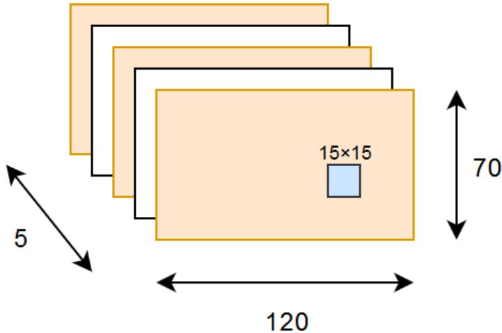
**Slika 2.8.** Primjer konvolucijskog sloja dimenzija  $120 \times 70 \times 5$  i veličine filtara  $15 \times 15$
