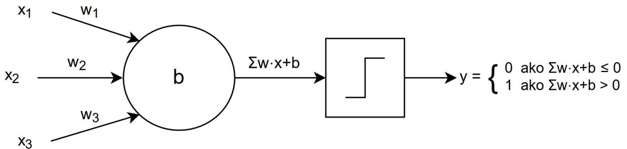
**Slika 2.4.** Neuron sa step aktivacijskom funkcijom (perceptron)
