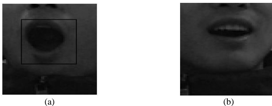
Sl. 2.2. Uspješna detekcija (a) zijevanja i (b) normalnog stanja usta [5]
