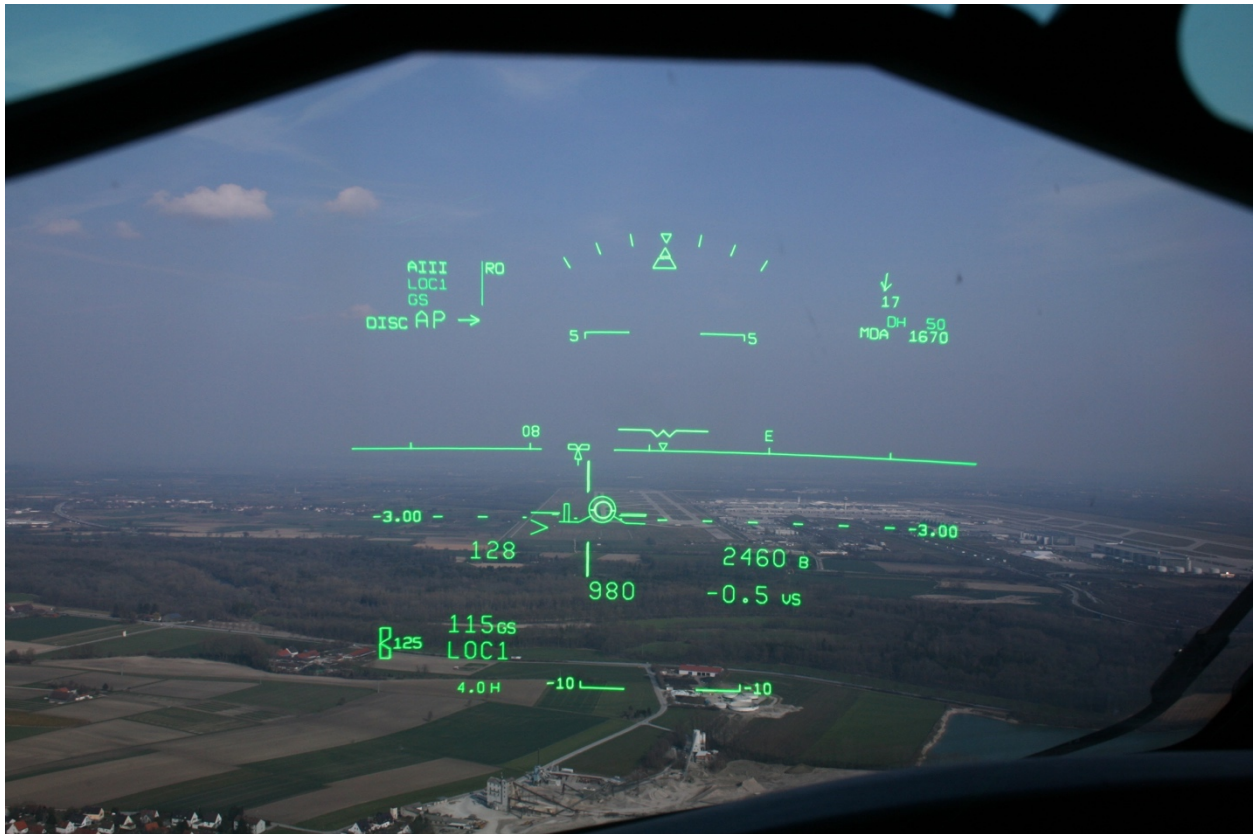
Sl. 2.1. Prikaz HUD-a u zrakoplovu [9]
