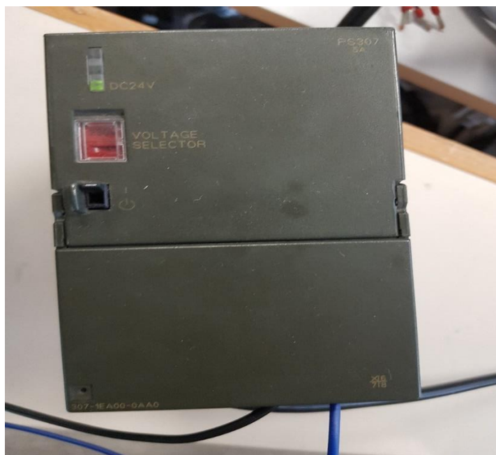
Slika 3.7. Ispravljач SIMATIC S7.
