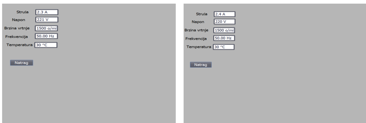
Slika 4.4. Prikaz veličina za rad motora naprijed (lijevo) i reverz (desno).
