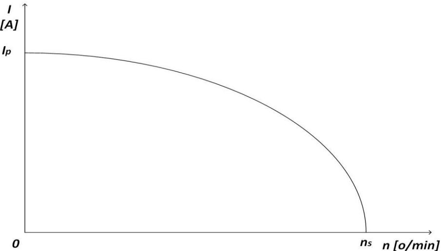
**Slika 2.11.** Ovisnost rotorske struje o brzini vrtnje (klizanju)
