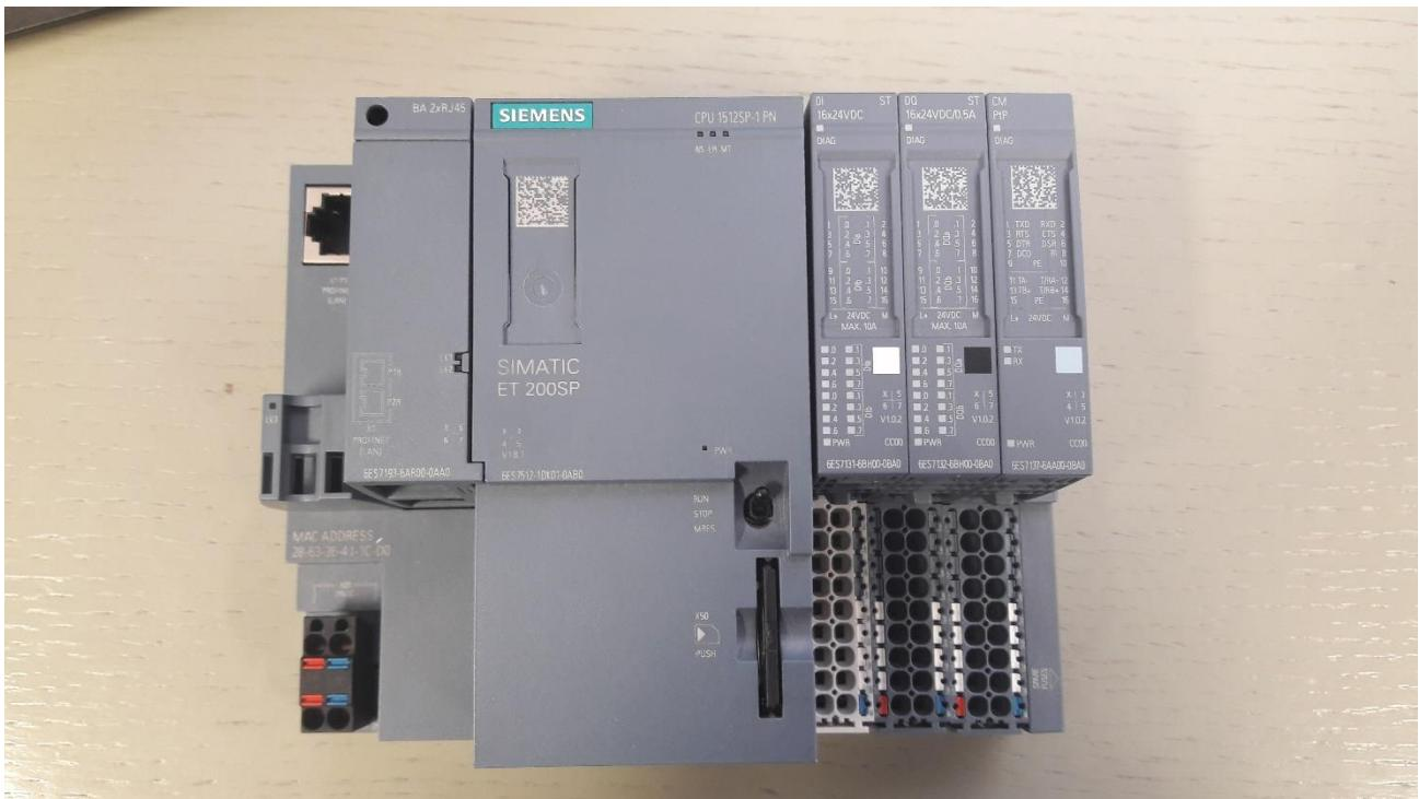
**Slika 2.2. PLC SIMATIC S7-1500 s pripadajućim modulima.**
