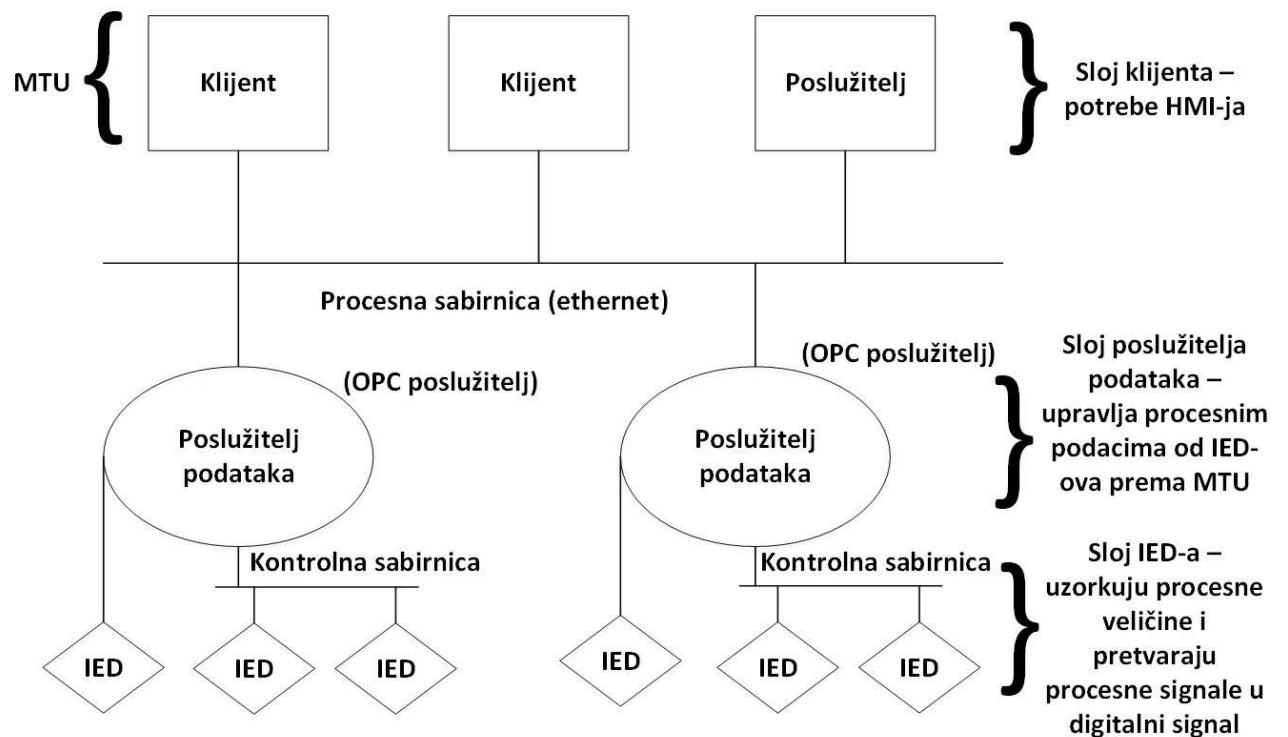
**Slika 2.3.** Sklopovska struktura SCADA-e.
