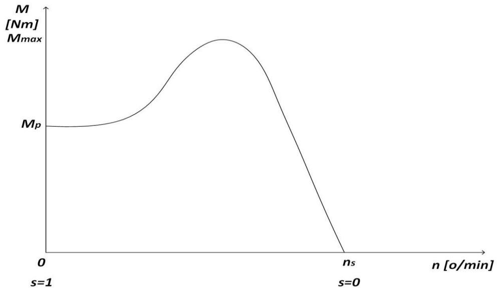
**Slika 2.12.** Momentna karakteristika asinkronog motora
