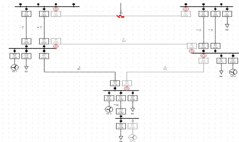
**Sl. 6.131.** Djelovanje zaštite pri KS na vodu 3 uz priključene tri VE (doprinos struji KS 6In) na sabirnicama bus3, bus4 i bus5
