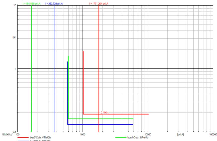
**Sl. 6.122.** I-t dijagrami releja za kratki spoj na vodu 3 uz priključene tri VE (doprinos struji KS 6In) na sabirnicama bus3, bus5 i bus6
