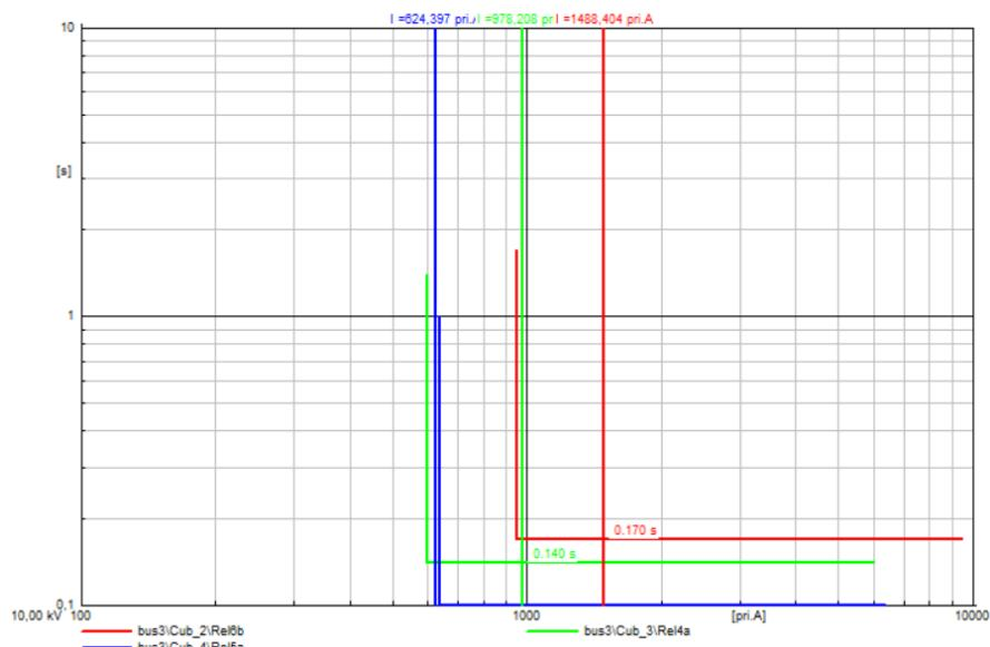
**Sl. 6.62.** I-t dijagrami releja za kratki spoj na sabirnici bus3 uz priključene tri VE (doprinos struji KS 1,1In) na sabirnicama bus3, bus4 i bus6
