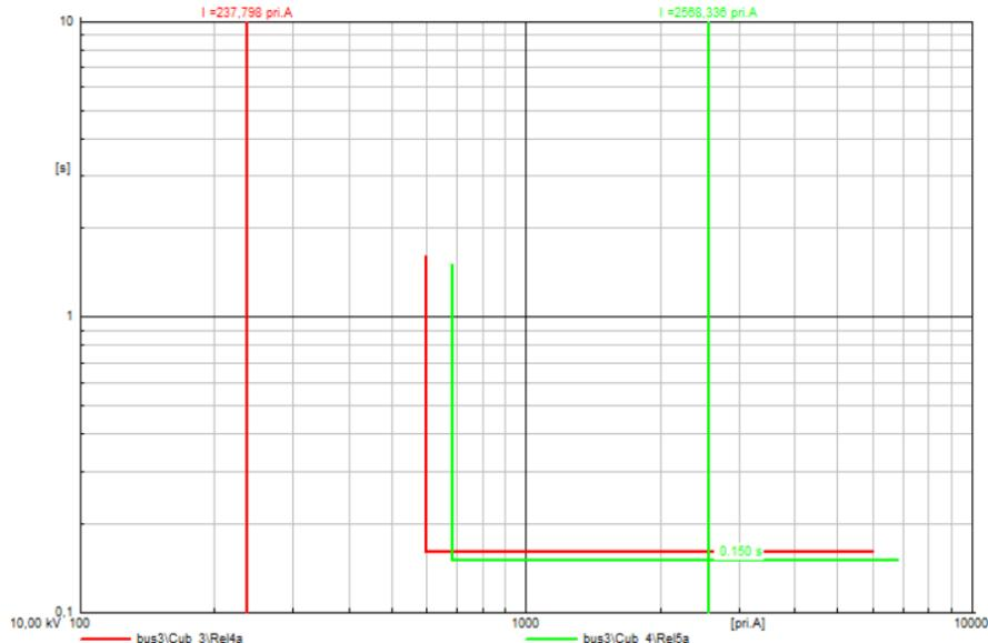
**Sl. 6.58.** I-t dijagrami releja za kratki spoj na vodu 5 uz priključene tri VE (doprinos struji KS 1,1In) na sabirnicama bus3, bus5 i bus6
