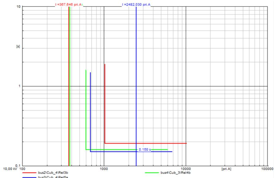
**Sl. 6.72.** I-t dijagrami releja za kratki spoj na vodu 5 uz priključene tri VE (doprinos struji KS 1,1In) na sabirnicama bus4, bus5 i bus6
