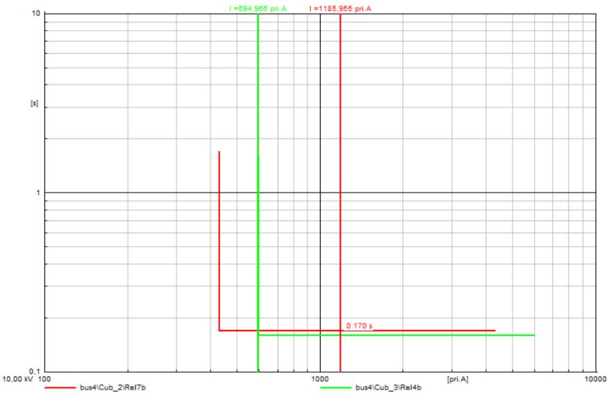
**Sl. 6.14.** I-t dijagrami releja za kratki spoj na vodu 7 (2) uz priključene dvije VE (doprinos struje KS 1,1In) na sabirnice bus4 i bus5
