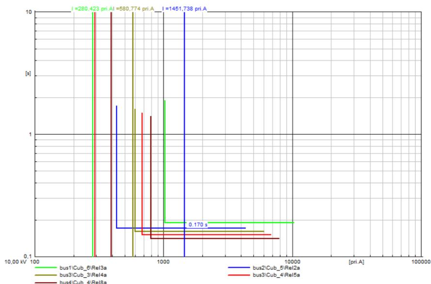
**Sl. 6.74.** I-t dijagrami releja za kratki spoj na vodu 2 (7) uz priključene tri VE (doprinos struji KS 1,IIIn) na sabirnicama bus4, bus5 i bus6
