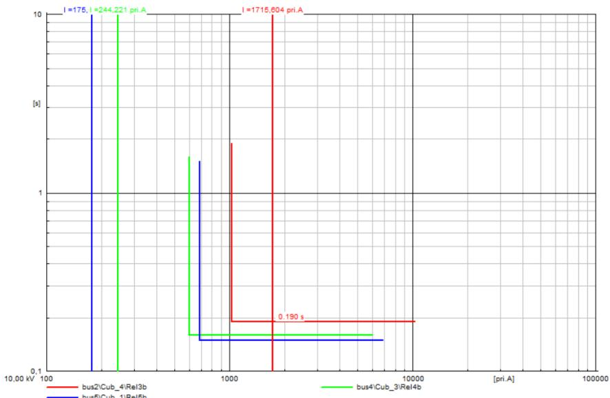
**Sl. 6.16.** I-t dijagrami releja za kratki spoj na vodu 3 uz priključene dvije VE (doprinos struji KS 1,1In) na sabirnice bus4 i bus5
