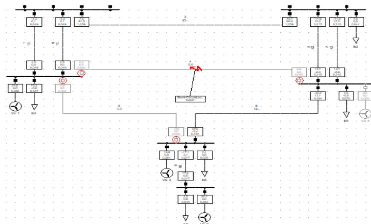
**Sl. 6.117.** Djelovanje zaštite pri KS na vodu 4 uz priključene tri VE (doprinos struji KS 6In) na sabirnicama bus3, bus5 i bus6
