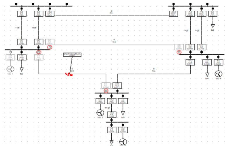
**Sl. 6.148.** Djelovanje zaštite pri KS na vodu 5 uz priključene tri VE na sabirnicama bus4, bus5 i bus6
