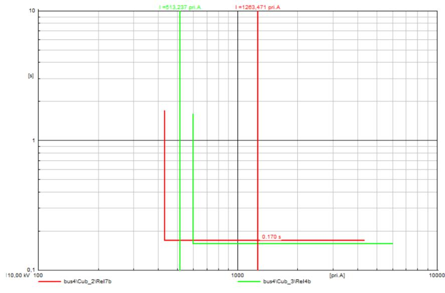
**Sl. 6.30.** I-t dijagrami releja za kratki spoj na vodu 7 (2) uz priključene dvije VE (doprinos struji KS 3In) na sabirnice bus4 i bus6
