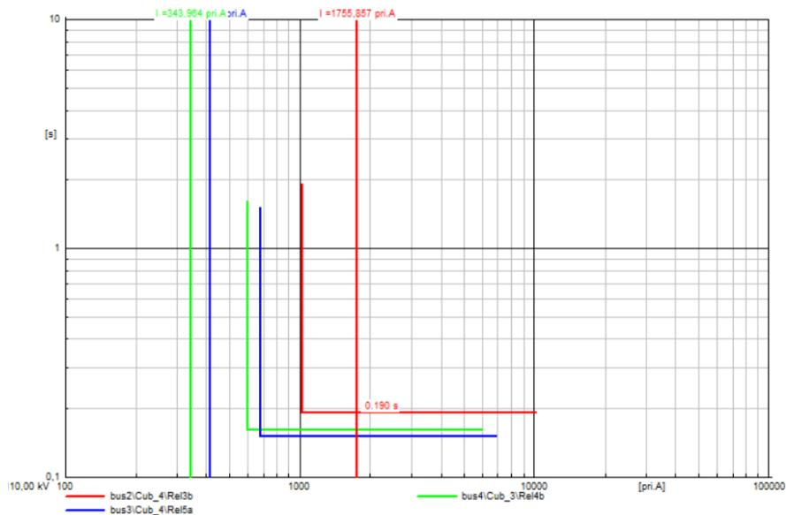
**Sl. 6.110.** *I-t dijagrami releja za kratki spoj na vodu 3 uz priključene tri VE (doprinos struji KS 3In) na sabirnicama bus4, bus5 i bus6*
