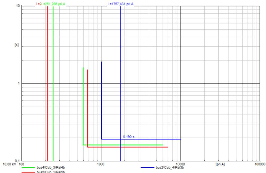
**Sl. 6.96.** I-t dijagrami releja za kratki spoj na vodu 3 uz priključene tri VE (doprinos struji KS 3In) na sabirnicama bus3, bus4 i bus5
