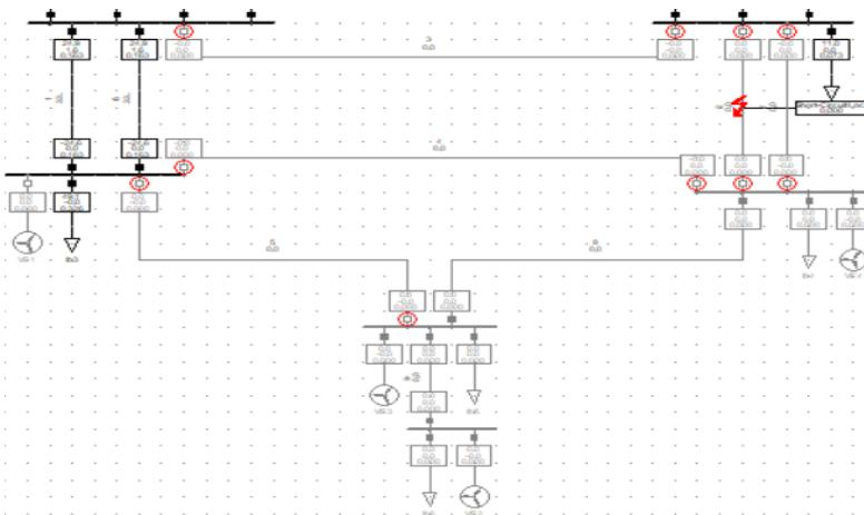
**Sl. 6.73.** Djelovanje zaštite pri KS na vodu 2 (7) uz priključene tri VE (doprinos struji KS 1,IIIn) na sabirnicama bus4, bus5 i bus6
