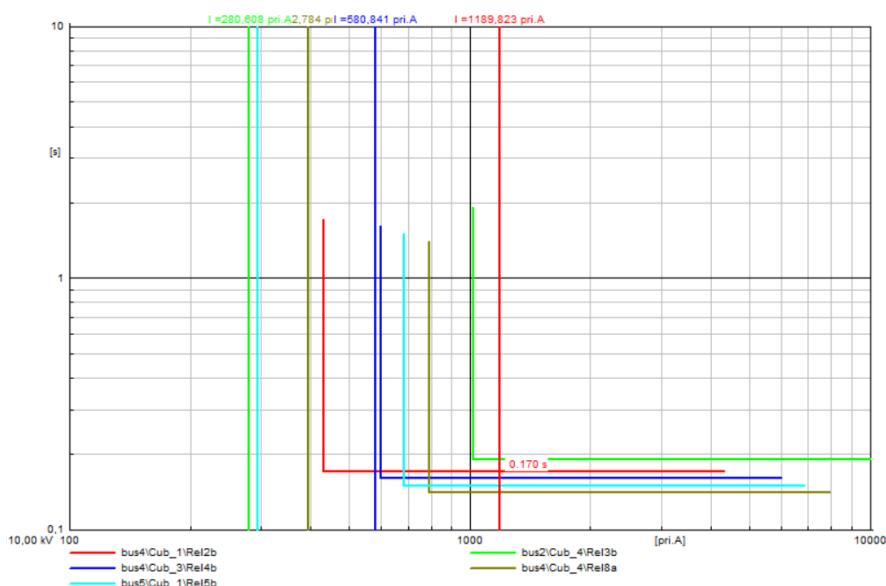
**Sl. 6.64.** I-t dijagrami releja za kratki spoj na sabirnici bus3 uz priključene tri VE (doprinos struji KS 1,1In) na sabirnicama bus4, bus5 i bus6
