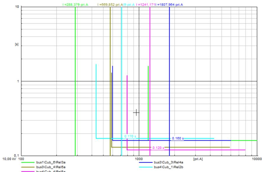
**Sl. 6.92.** I-t dijagrami releja za kratki spoj na sabirnici bus4 uz priključene tri VE (doprinos struja KS 3In) na sabirnicama bus3, bus4 i bus5
