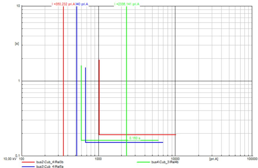
**Sl. 6.104.** I-t dijagrami releja za kratki spoj na vodu 4 uz priključene tri VE (doprinos struji KS 3In) na sabirnicama bus4, bus5 i bus6
