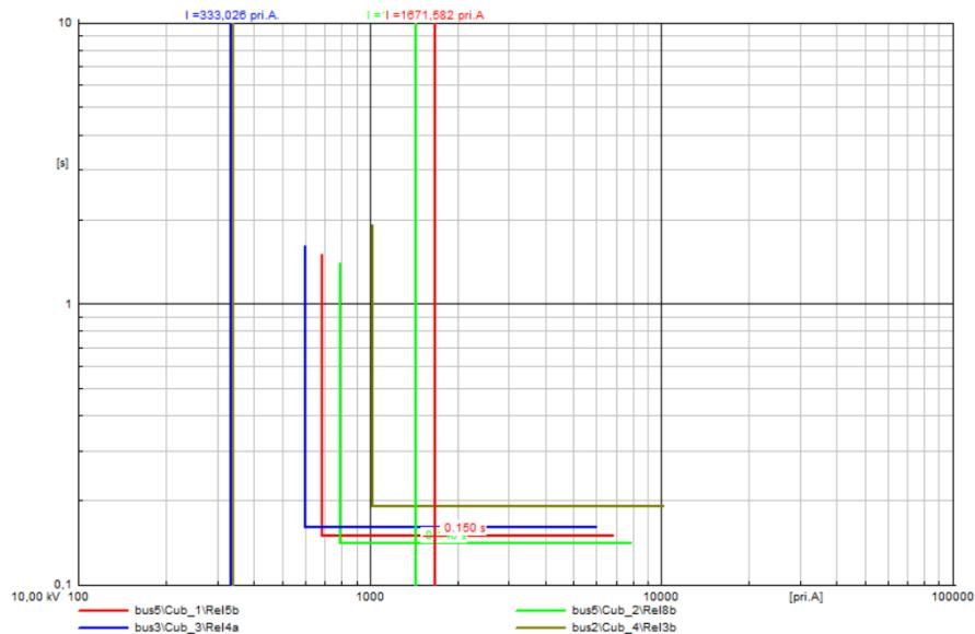
**Sl. 6.66.** I-t dijagrami releja za kratki spoj na sabirnici bus5 uz priključene tri VE (doprinos struji KS 1,1In) na sabirnicama bus4, bus5 i bus6
