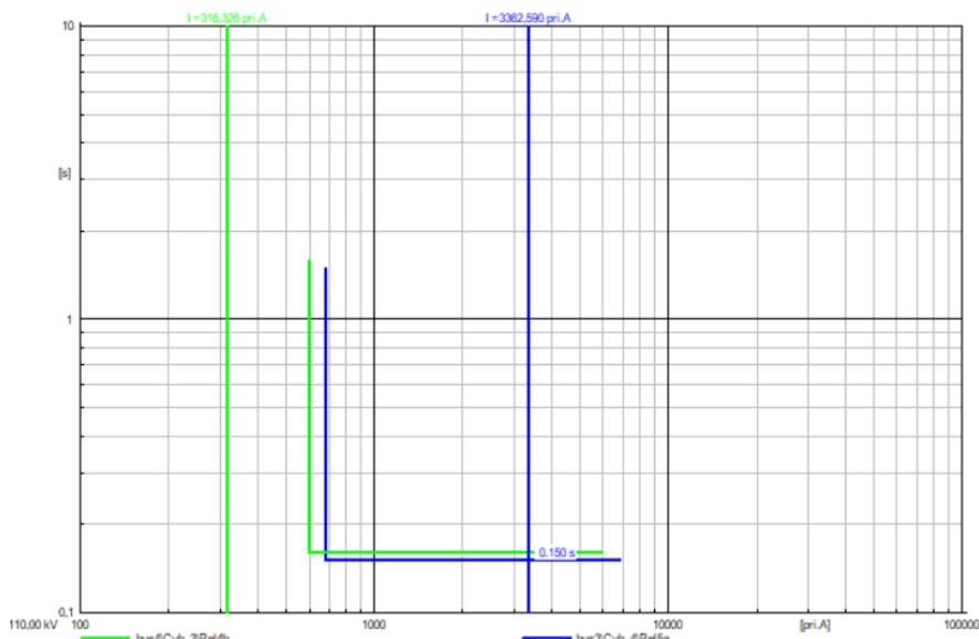
**Sl. 6.120.** I-t dijagrami releja za kratki spoj na vodu 5 uz priključene tri VE (doprinos struji KS 6In) na sabirnicama bus3, bus5 i bus6
