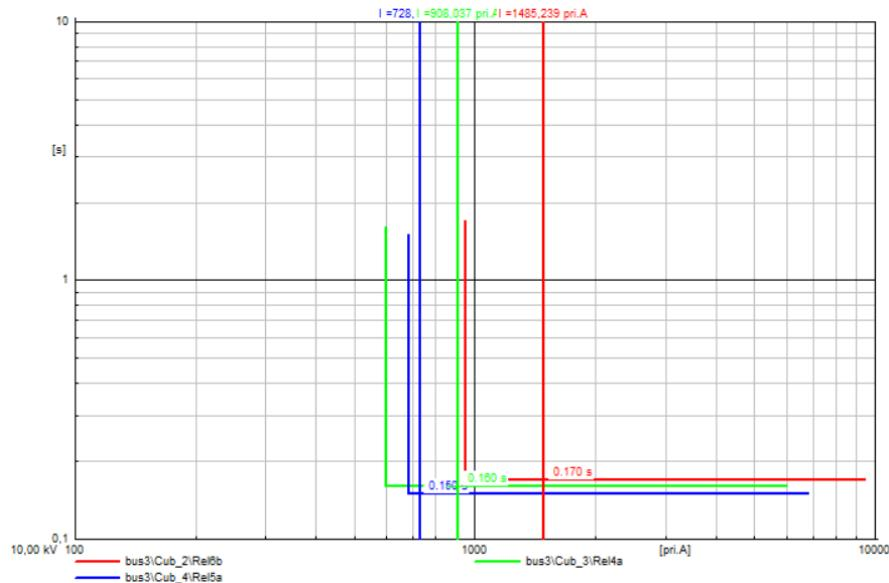
**Sl. 6.8.** I-t dijagrami releja za kratki spoj na sabirnici bus3 uz priključene dvije VE (doprinos struji KS 1, IIn) na sabirnice bus5 i bus6
