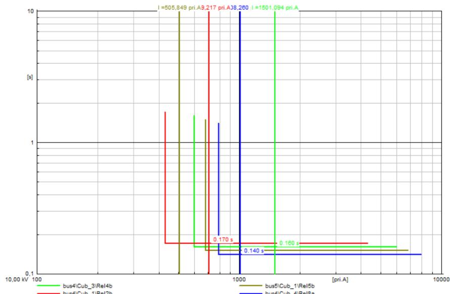
**Sl. 6.68.** I-t dijagrami releja za kratki spoj na sabirnici bus4 uz priključene tri VE (doprinos struji KS 1,1In) na sabirnicama bus4, bus5 i bus6
