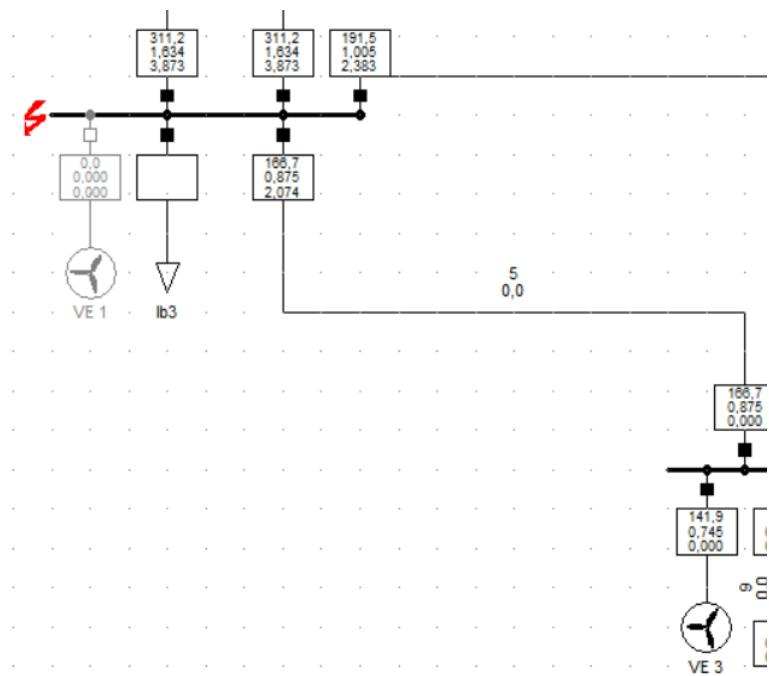
**Sl. 6.3.** Prikaz simulacije kratkog spoja na sabirnici bus3 s prikazanim vrijednostima struje kratkog spoja uz priključenu VE (doprinos struji KS 3In) na sabirnici bus5
