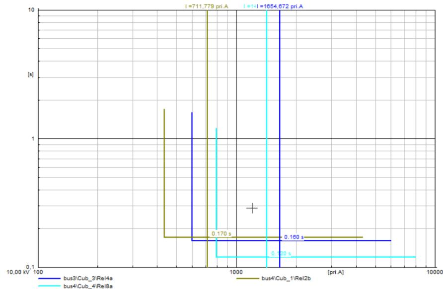
**Sl. 6.100.** I-t dijagrami releja za kratki spoj na sabirnici bus4 uz priključene tri VE (doprinos struji KS 3In) na sabirnicama bus4, bus5 i bus6
