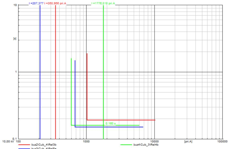
**Sl. 6.70.** I-t dijagrami releja za kratki spoj na vodu 4 uz priključene tri VE (doprinos struji KS 1,1In) na sabirnicama bus4, bus5 i bus6
