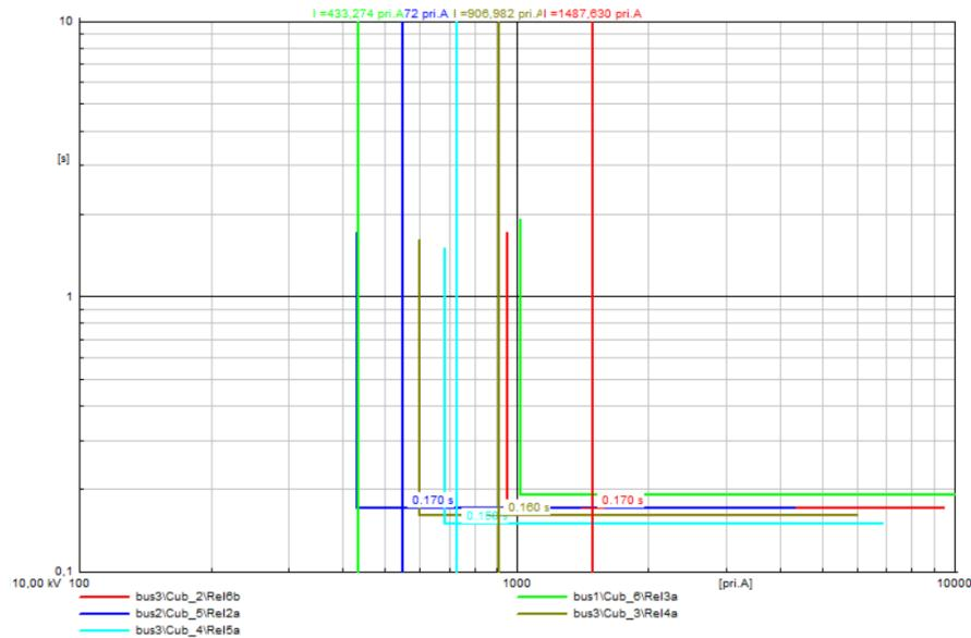
**Sl. 6.50.** I-t dijagrami releja za kratki spoj na sabirnici bus3 uz priključene tri VE (doprinos struje KS 1,1In) na sabirnicama bus3, bus5 i bus6
