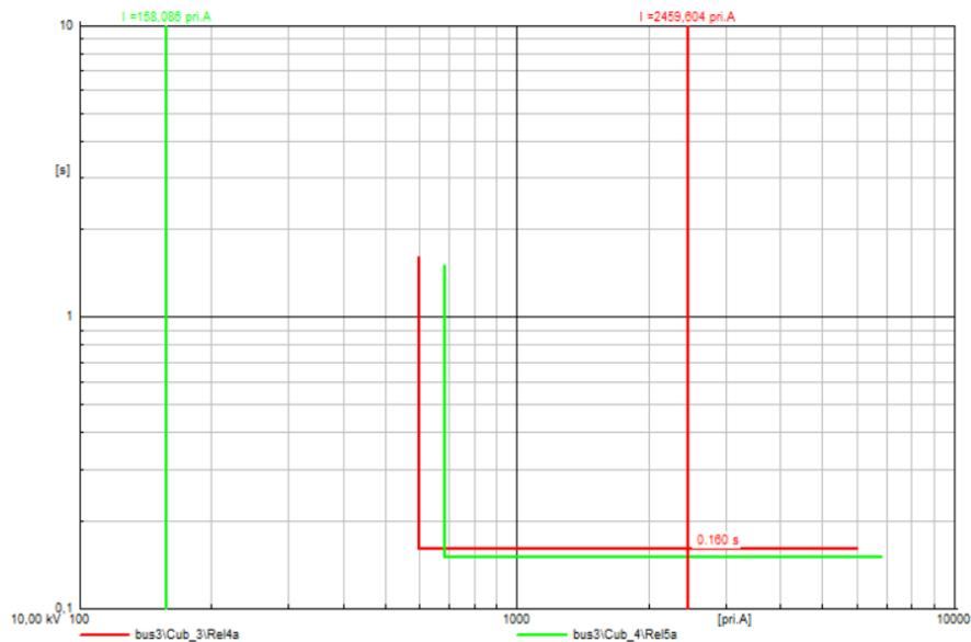
Sl. 6.56. I-t dijagrami releja za kratki spoj na vodu 4 uz priključene tri VE (doprinos struji KS 1, IIn) na sabirnicama bus3, bus5 i bus6
