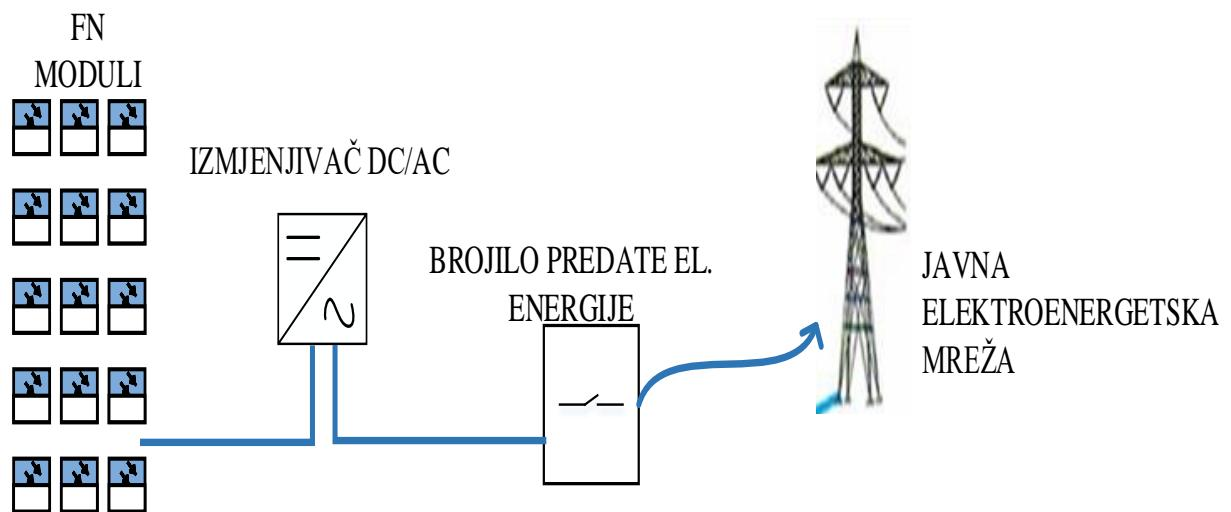
Slika 4.2. Fotonaponski sustav izravno spojen na elektroenergetsku mrežu
