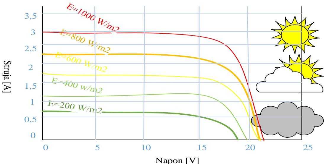
**Slika 3.6. Utjecaj intenziteta Sunčeva zračenja na strujno-naponske karakteristike fotonaponskog modula**
