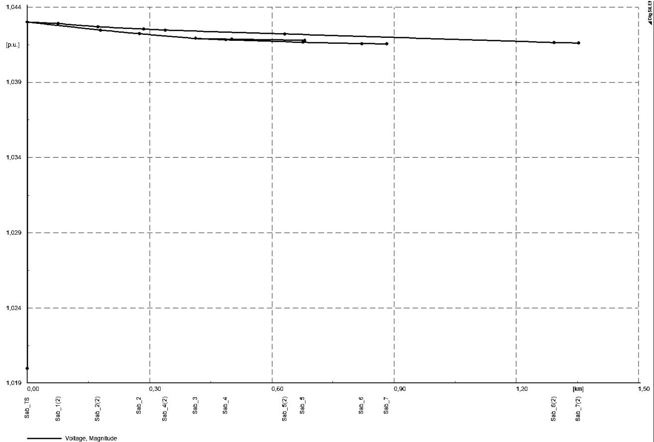
**Slika 6.15. Naponski profil nakon priključenja svih fotonaponskih elektrana**
