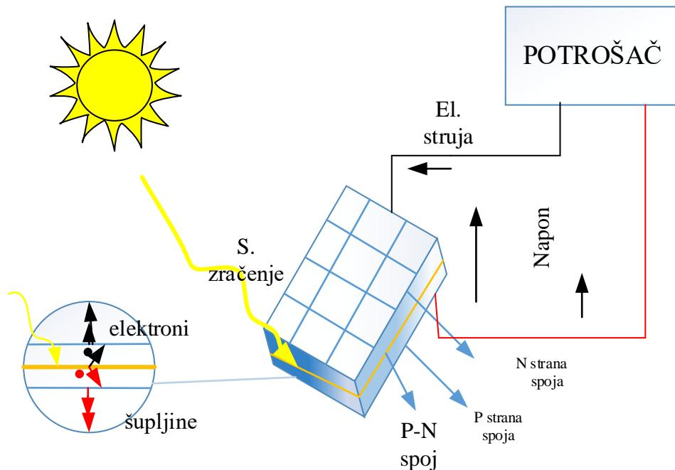
**Slika 3.2 Primjer funkciranja fotonaponske čelije**
