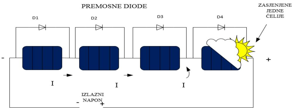
**Slika 3.5. Premosna dioda u paralelnom spoju s djelomično zasjenjenom čelijom**
