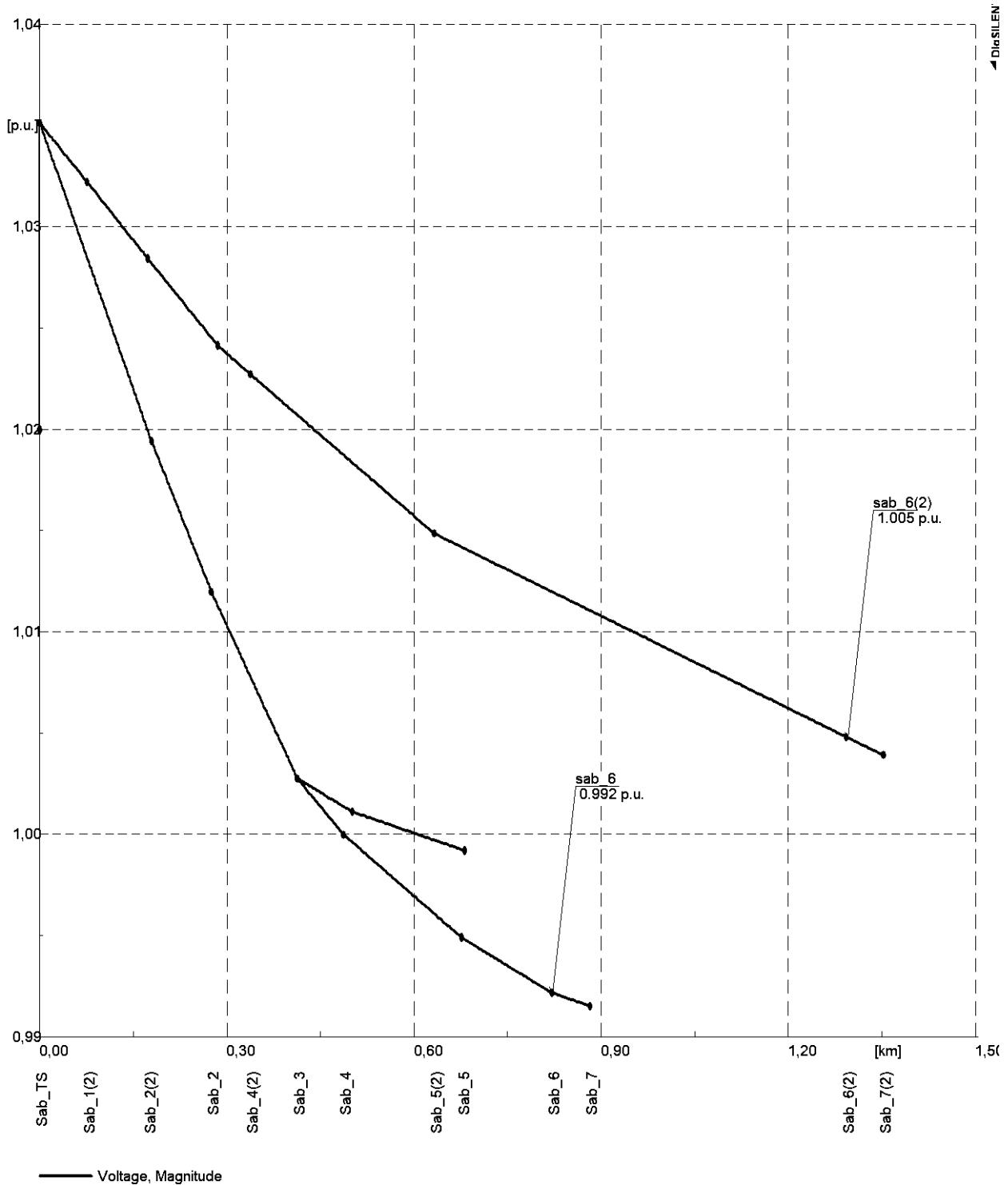
**Slika 6.3. Naponski profil prije priključenja fotonaponskih elektrana**
