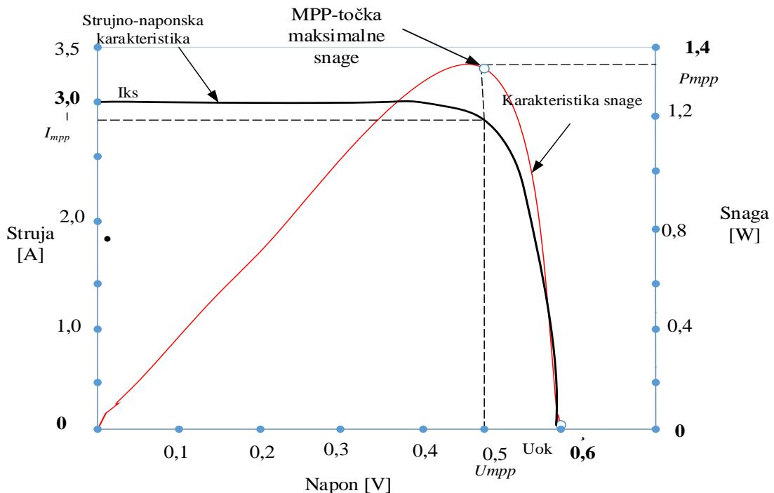
Slika 3.4. Strujno-naponska karakteristika i karakteristika snage fotonaponske ćelije [2]
