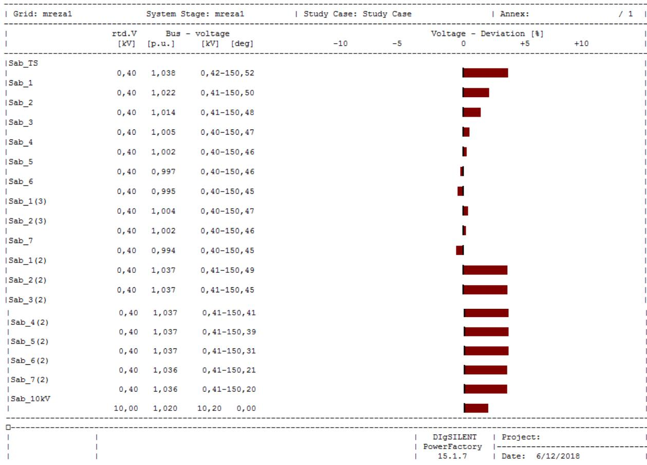
**Slika 6.12. Prikaz odstupanja napona po pojedinim sabirnicama 0,4 kV i 10 kV nakon priključenja fotonaponskih elektrana na desnom izvodu**
