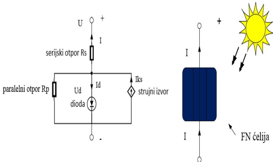
**Slika 3.3. Nadomjesna shema fotonaponske čelije**
