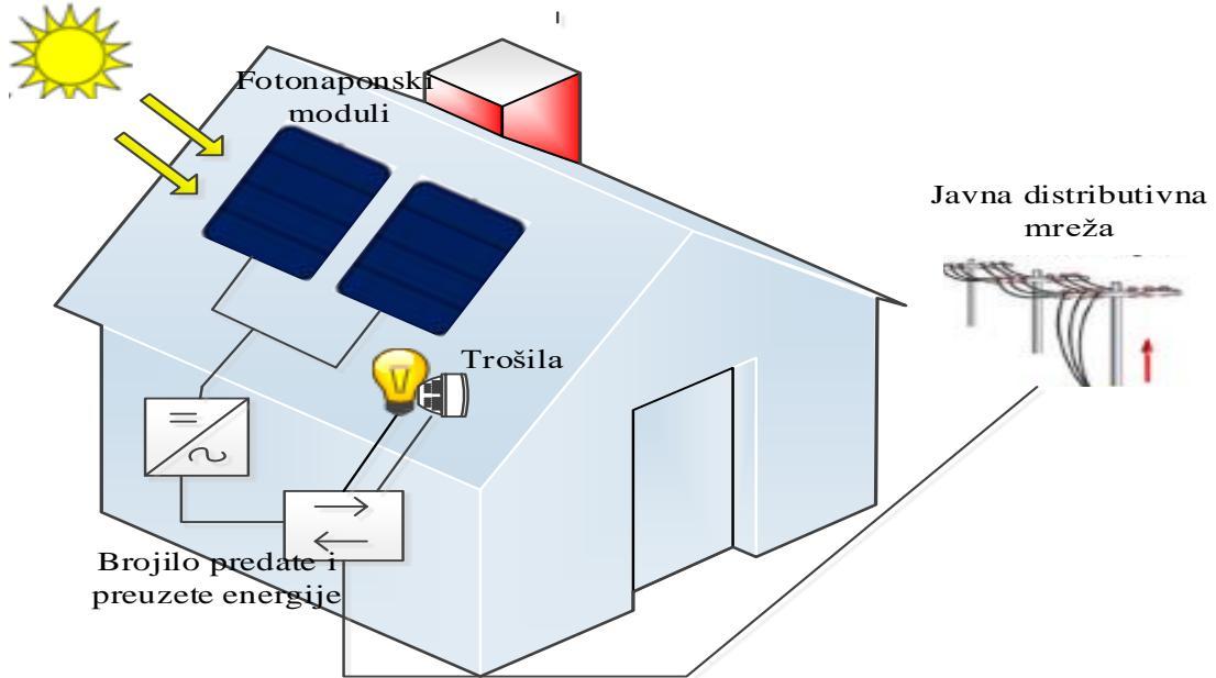
**Slika 4.1. Shema fotonaponskog sustava povezanog na javnu elektroenergetsku mrežu preko kućne instalacije**
