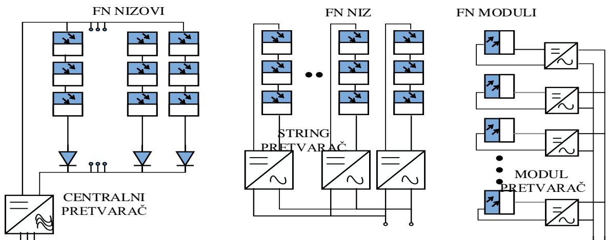
**Slika 3.11. Shema fotonaponskog sustava spojenog na mrežu pomoću tri različite topologije invertera**
