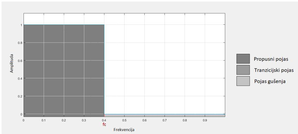
**Sl 2.3.** Prijenosna karakteristika idealnog filtra u frekvencijskoj domeni
