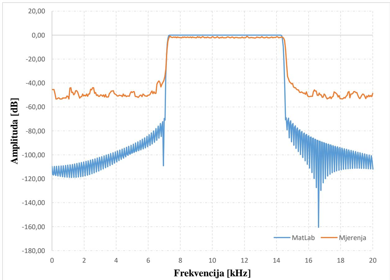
**Sl. 4.145** Rezultati mjerena frekvencijskog odziva pojasnopravljajućeg filtra 680 reda
