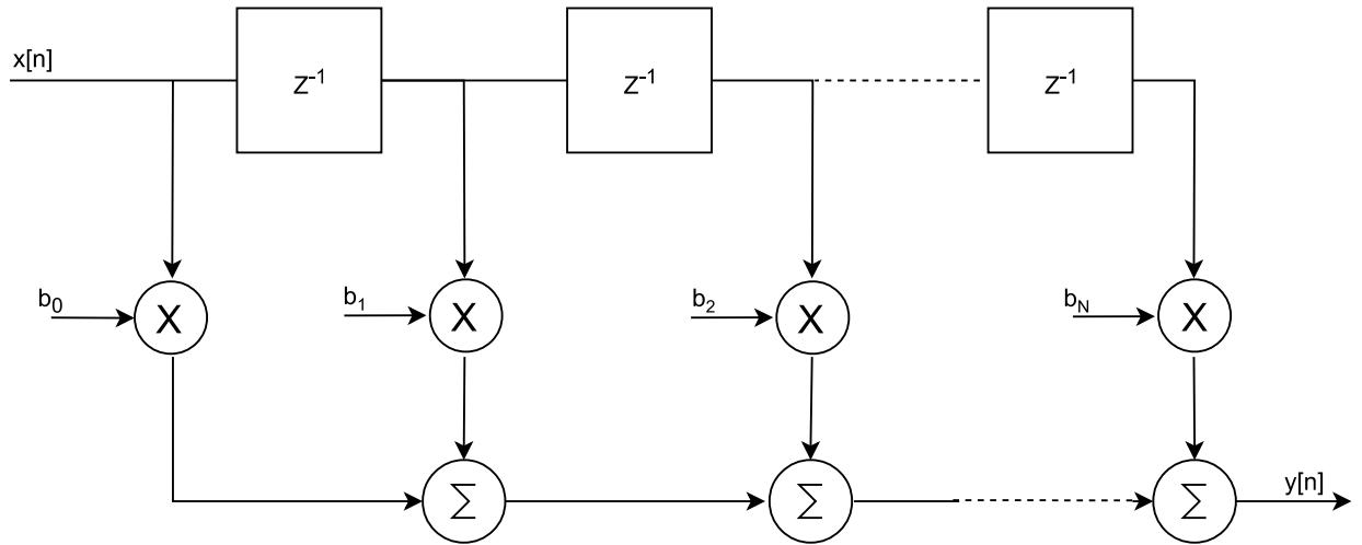
*Slika 2.7. Blok shema FIR filtra*
