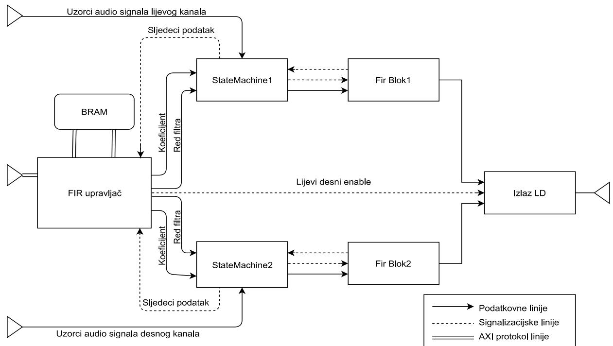
**Sl. 4.6 Blok shema entiteta Filter blok**
