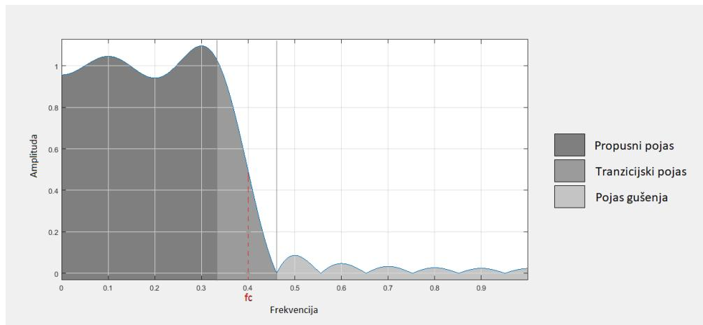
**Sl 2.4.** Prijenosna karakteristika stvarnog filtra u frekvencijskoj domeni dobivena u MatLab-u
