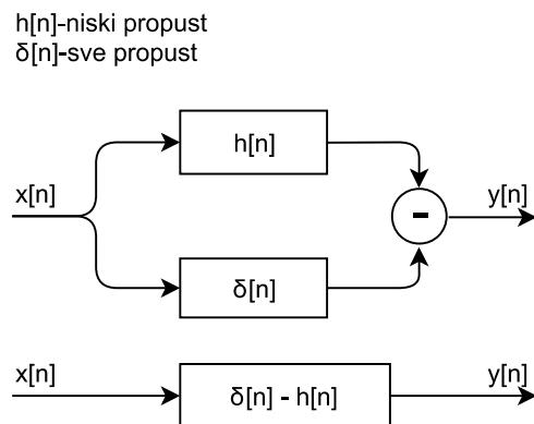
*Sl. 2.13. Postupak izračuna koeficijenta visokopropusnog filtra*
