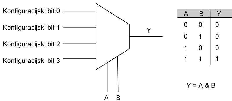
*Sl. 3.3 LUT element i prikaz logičke tablice za konfiguraciju rada kao I logička vrata*
