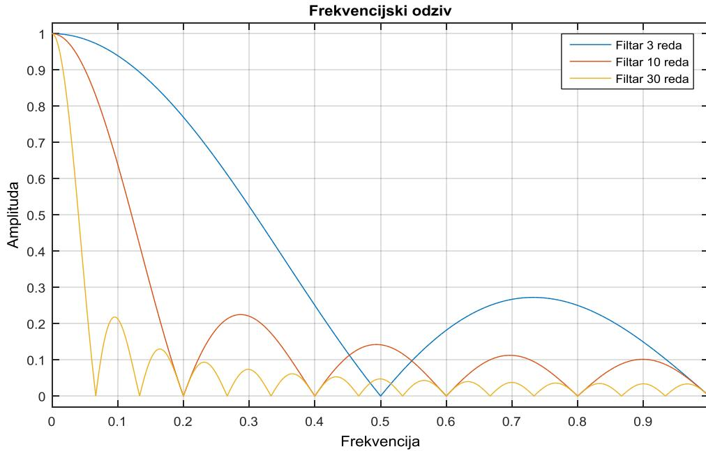
Sl. 2.10. Frekvenčni odziv filtra pomične srednje vrijednosti u ovisnosti o redu filtra
