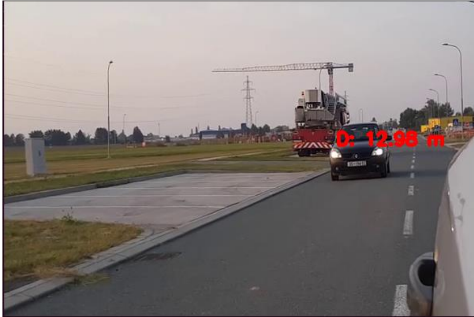
Sl. 3.9. Procjena udaljenosti detektiranog vozila, kamera Samsung Galaxy S8
