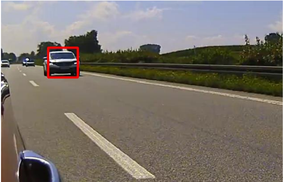
Sl. 3.7. Detektirano željeno vozilo pomoću dobro istreniranog detektora, kamera RDACM23
