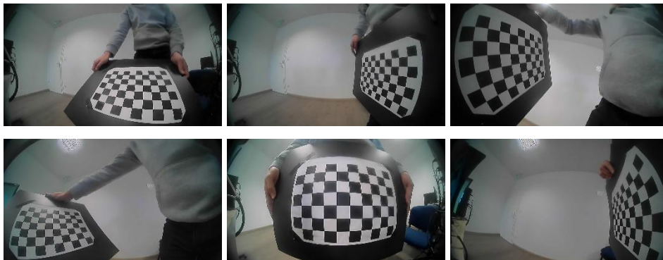
Sl.3.3. Neke od kalibracijskih slika korištenih za kalibraciju kamere u ovom diplomskom radu
