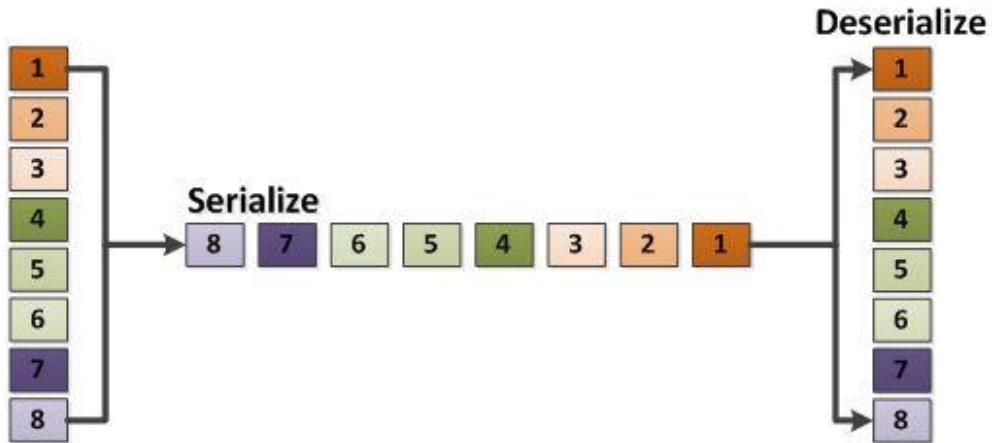
**Slika 2.7.** Pojednostavljeni prikaz rada *serializera* i *deserializera*. [7]
