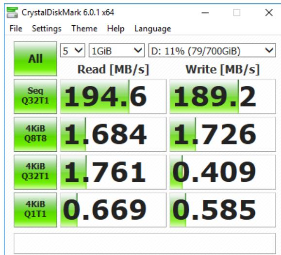
Slika 5.1. Brzine mehaničkog diska.
