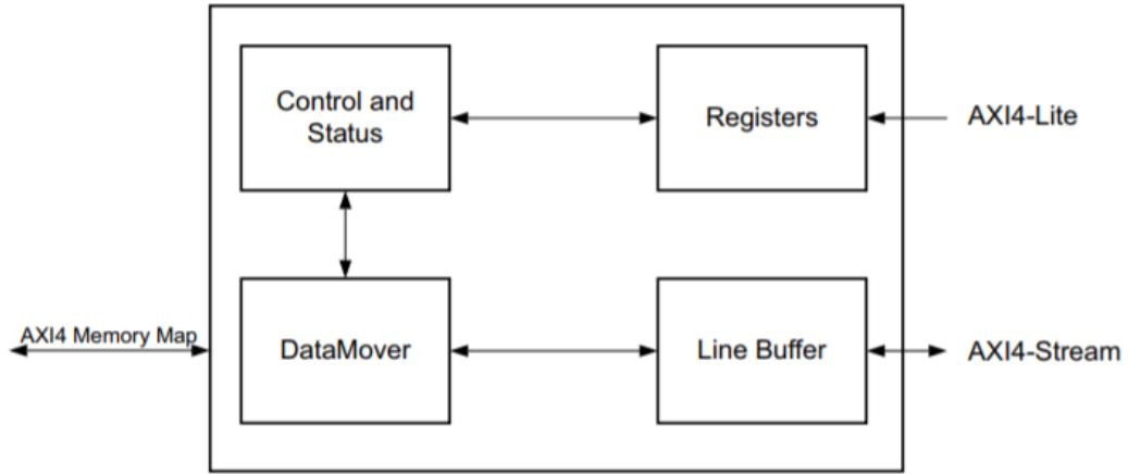
**Slika 2.9.** Blok dijagram VDMA bloka implementiranog na programabilnoj logici procesora [12].
