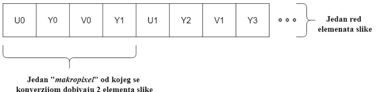
**Slika 2.5.** Pojednostavljen prikaz slanja podataka YUV formatom.
