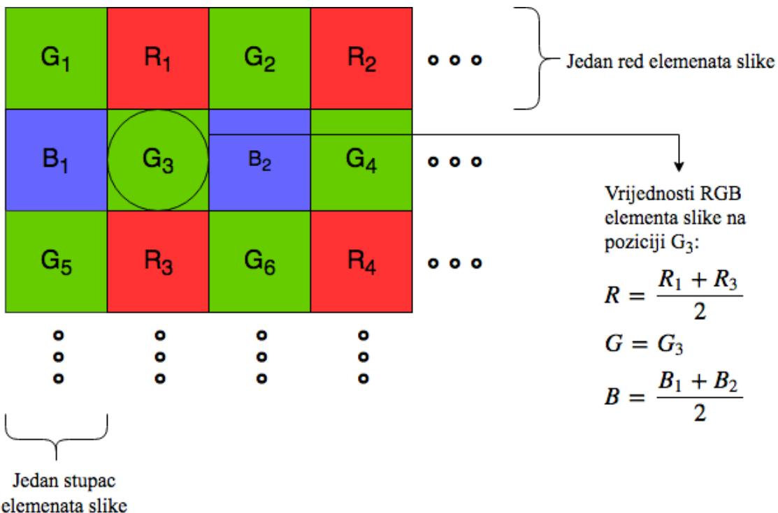
**Slika 2.4.** Pojednostavljen prikaz slanja podataka RAW formatom.
