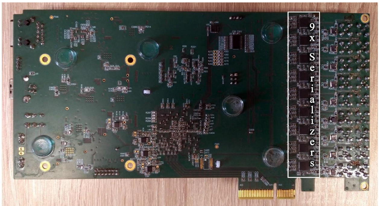
Slika 2.2. Prikaz stražnje strane AMV Grabber platforme sa označenim serializerima
