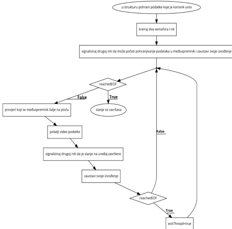
Sl. 3.8 Detaljni blok prikaz izvođenja prve niti
