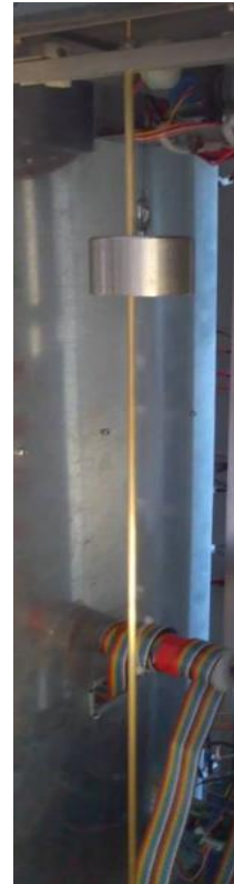
Slika 3.11. Protuuteg s pripadajućom vodilicom
