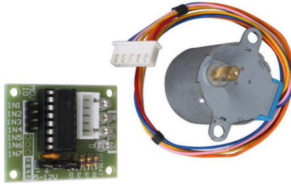
Slika 3.6. Upravljačka pločica ULN2003 i koračni motor 28BYJ-48[14]
