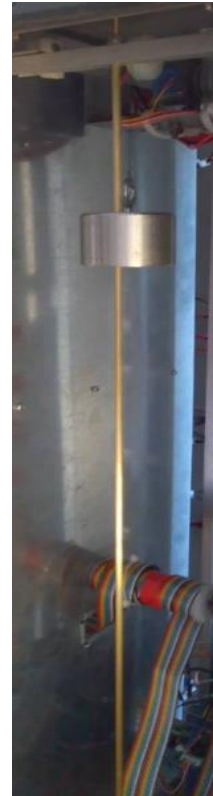
Slika 3.11. Protuuteg s pripadajućom vodilicom
