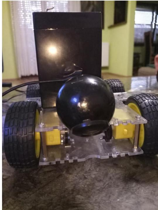
**Slika 3.13.** Platforma s kamerom za *line tracking*
