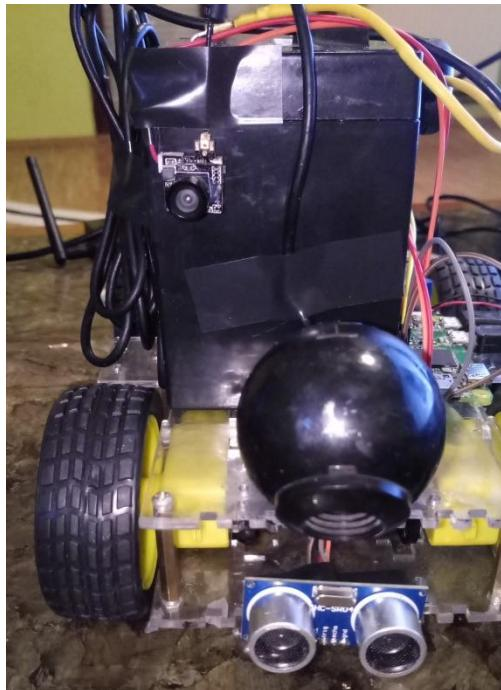
**Slika 3.15.** Platforma nakon dodane mini FPV kamere
