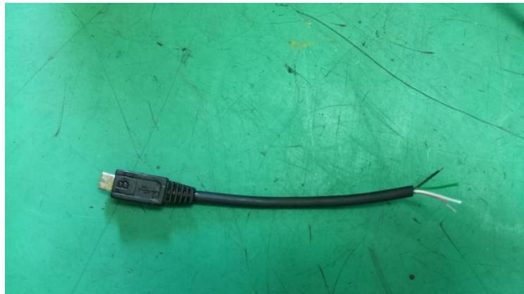
**Slika 3.16.** Micro USB kabel
