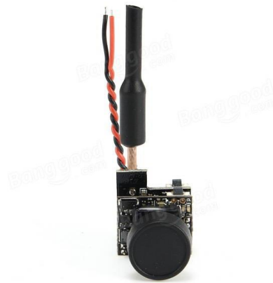
Slika 3.3. 5.8g fpv mini kamera
