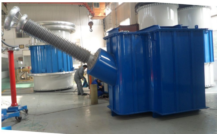
Sl.5.1.3. Ispitni transformator sa metalnim spremnikom
