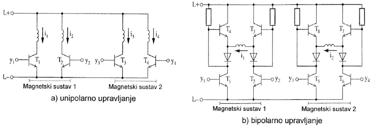
Slika 3.7. Napajanje pri unipolarnom i bipolarnom upravljanju [2]
