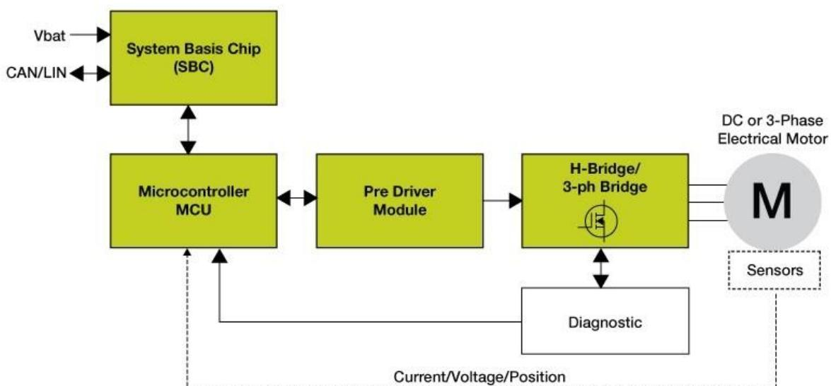
Slika 4.1. Blok shema digitalnog sustava upravljanja motora
