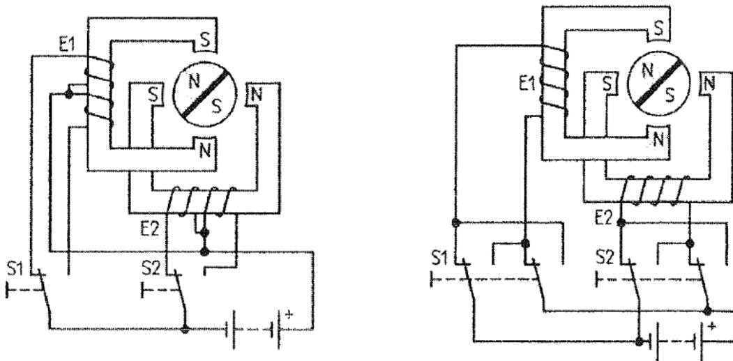
Slika 3.5. Unipolarno (lijevo) i bipolarno (desno) pokretanje dvofaznog četveropoljnog koračnog motora [2]
