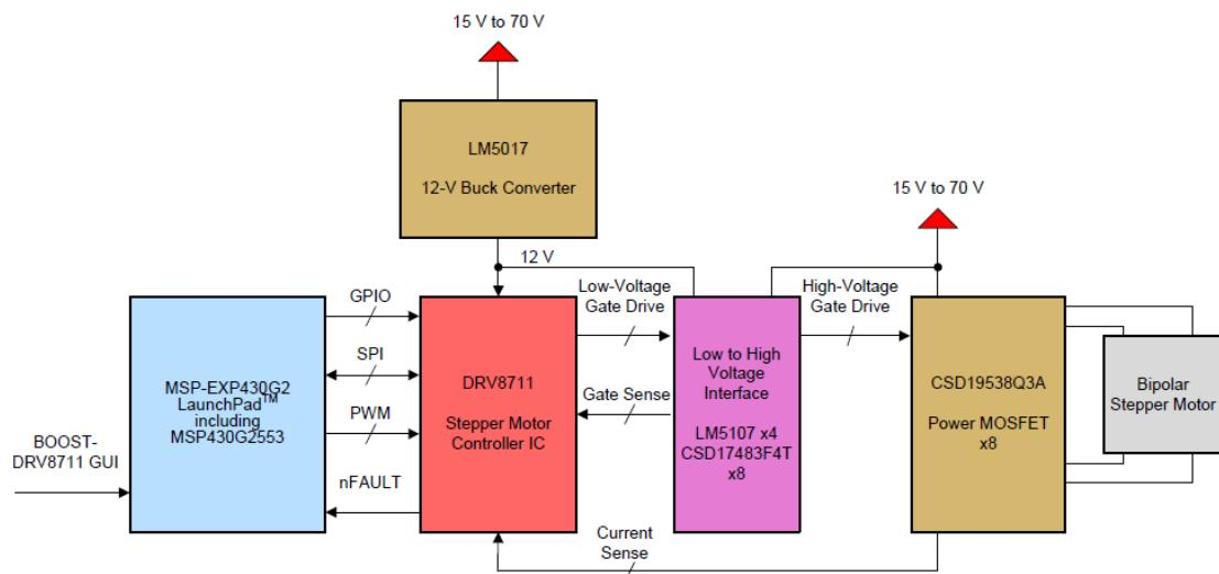
Slika 5.1. Blok dijagram sklopa za upravljanje koračnog motora [4]
