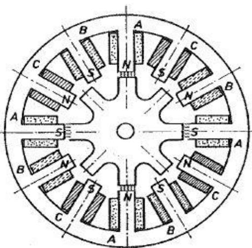
Slika 2.3. Presjek reluktantnog koračnog motora [2]
