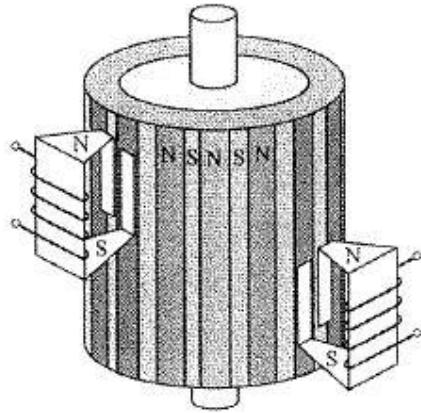
Slika 2.2. Permanentno uzbudjeni koračni motor [2]
