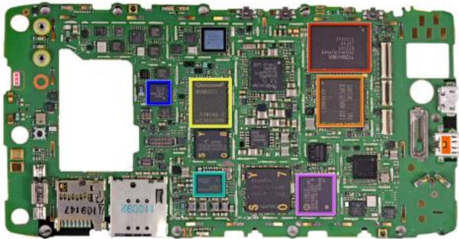
Slika 5.5. Arhitektura pametnih mobitela (SoC). [11]
