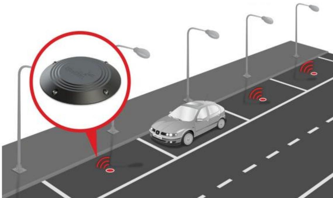
Slika 5.4. Primjer korištenja magnetskog senzora za otkrivanje prisutnosti. [24]
