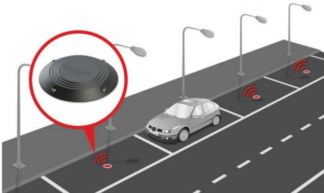
Slika 5.4. Primjer korištenja magnetskog senzora za otkrivanje prisutnosti. [24]
