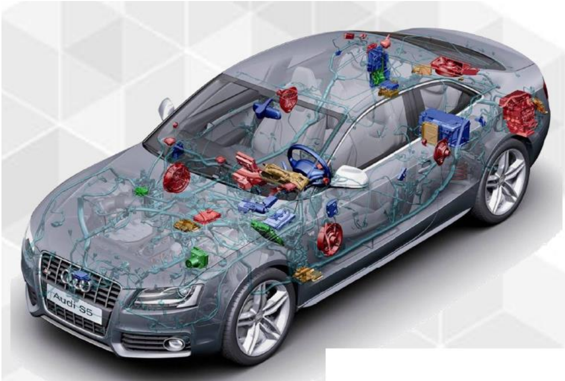
Slika 2.6. Primjer korištenja više različitih vrsta senzora, aktuatora i signalizacije u automobilu. [17]
