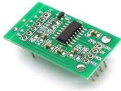
Sl. 3.10. Analogno digitalni pretvornik – HX711
