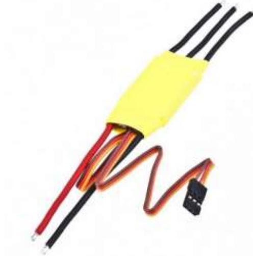
Sl. 3.5. Elektronički upravljač brzine (ESC)
