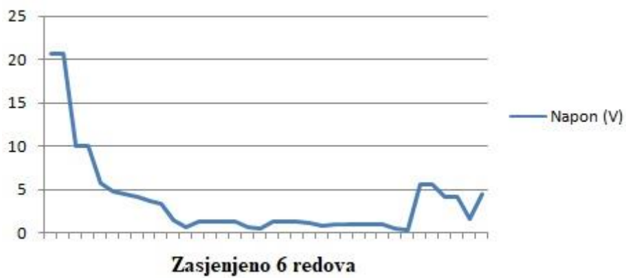
Slika 4.24. Promjena napona pri zasjeni 6 redova modula
