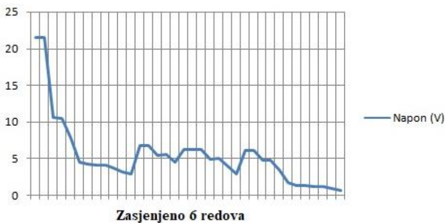
Slika 4.16. Promjena napona pri zasjeni 6 redova modula
