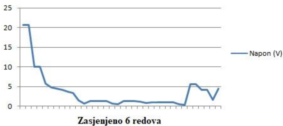
Slika 4.24. Promjena napona pri zasjeni 6 redova modula
