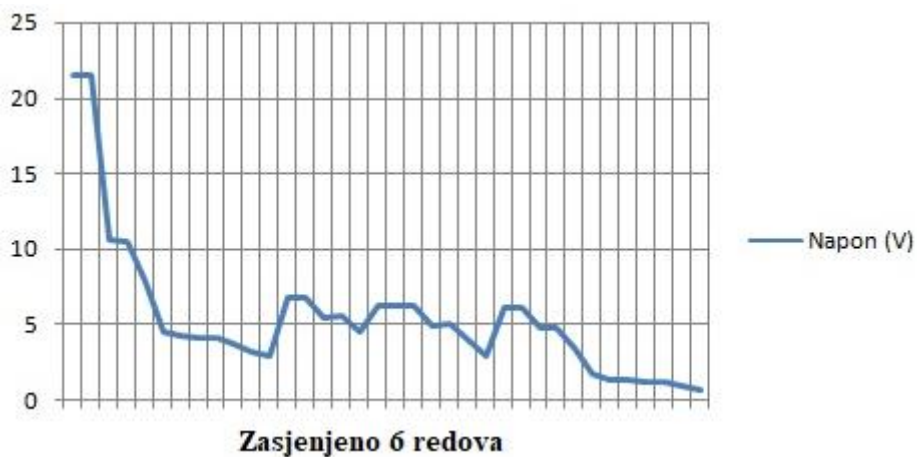
Slika 4.16. Promjena napona pri zasjeni 6 redova modula
