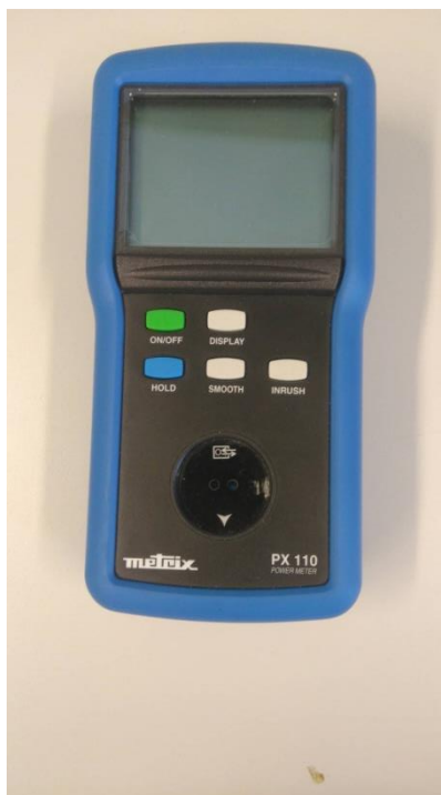
Slika 4.5. Mjerni uređaj Metrix PX-110 Powermeter
