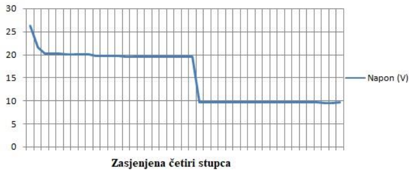
Slika 4.12. Promjena napona pri zasjeni četiri stupca fotonaponskog modula.
