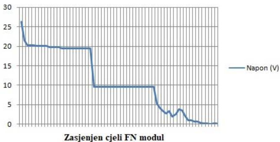
Slika 4.13. Oblik napona pri zasjeni cjelog FN modula.
