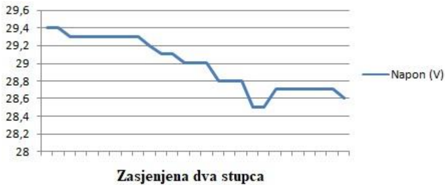
Slika 4.27. Promjena napona pri zasjeni dva stupca fotonaponskog modula.
