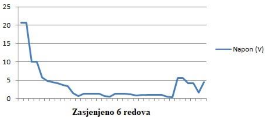
Slika 4.24. Promjena napona pri zasjeni 6 redova modula
