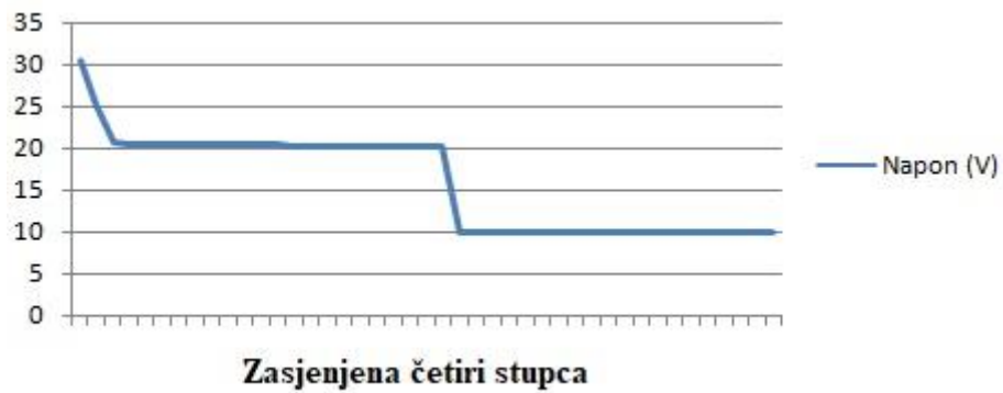
Slika 4.20. promjena napona pri zasjeni četiri stupca fotonaponskog modula.
