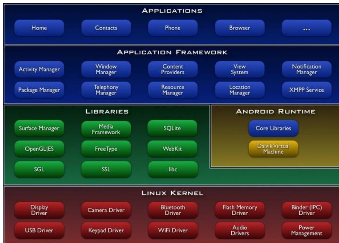
Sl. 2.3. Arhitektura Android operativnog sustava, prema [4].
