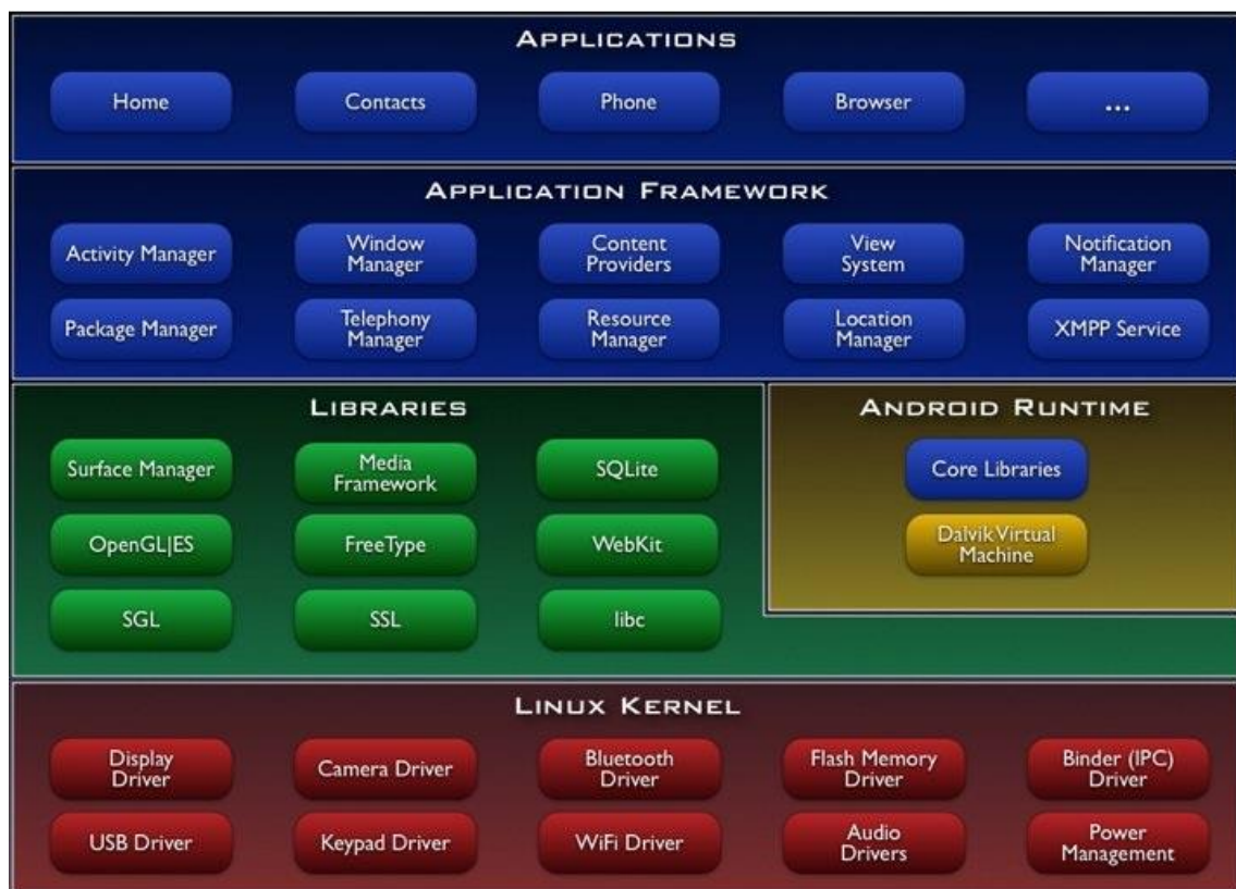
Sl. 2.3. Arhitektura Android operativnog sustava, prema [4].
