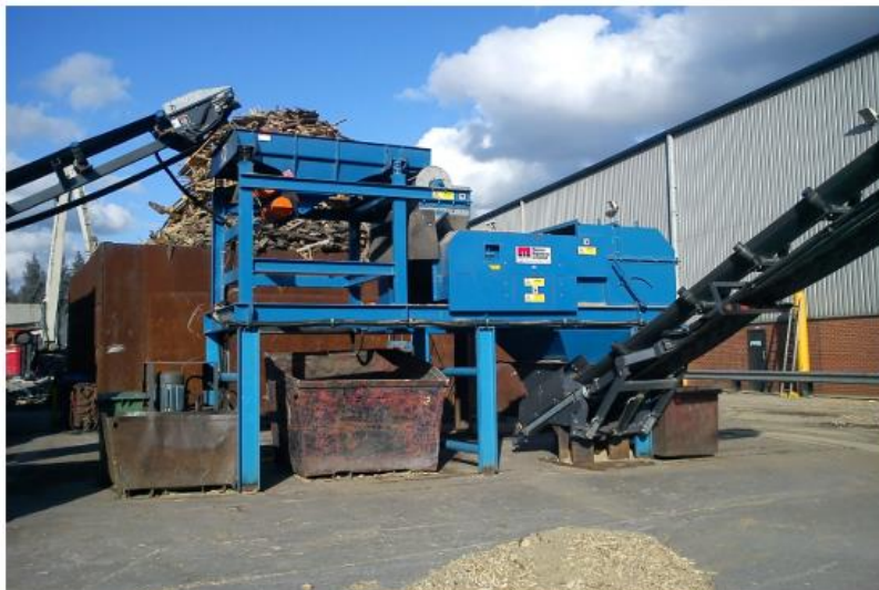
Slika 4.3. Separator na principu vrtložnih struja tvrtke Mastermagnets
