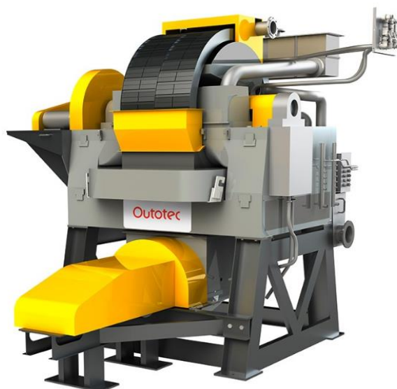
Slika 4.6. Separator za odvajanje jakim magnetskim poljima tvrtke Outotec
