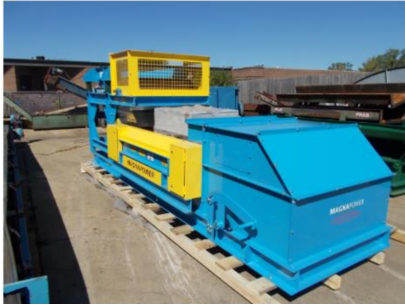
Slika 4.4. Separator na principu vrtložnih struja tvrtke Magnapower
