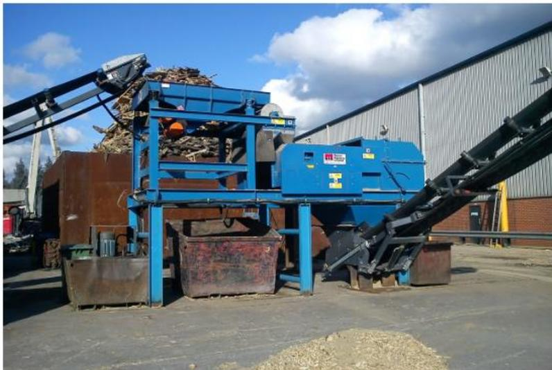
Slika 4.3. Separator na principu vrtložnih struja tvrtke Mastermagnets
