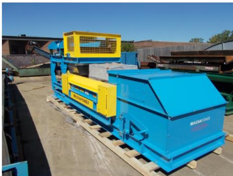
Slika 4.4. Separator na principu vrtložnih struja tvrtke Magnapower
