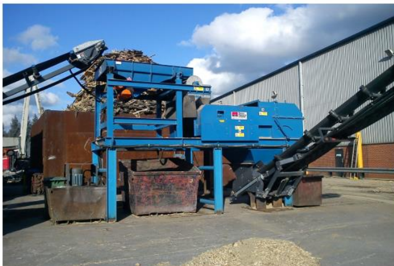
Slika 4.3. Separator na principu vrtložnih struja tvrtke Mastermagnets
