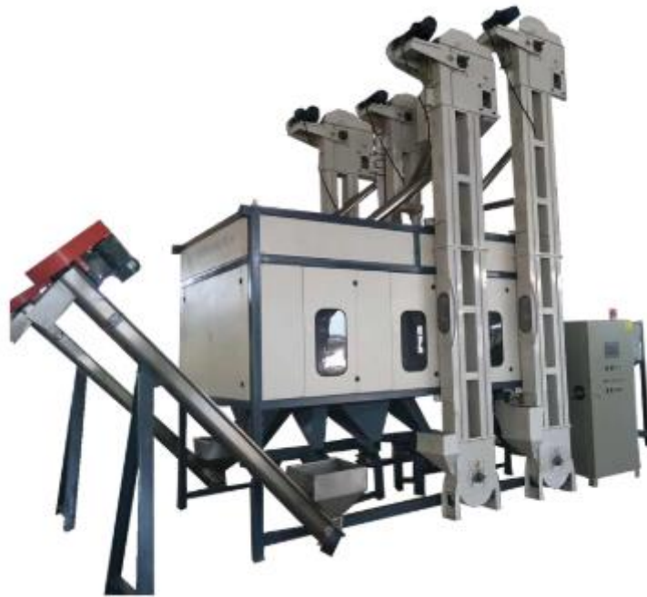
Slika 4.8. Separator HB1500 tvrtke Haibao Separator za elektrostatičko odvajanje plastike
