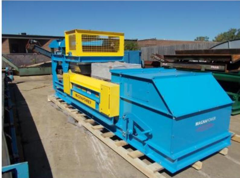
Slika 4.4. *Separator na principu vrtložnih struja tvrtke Magnapower*
