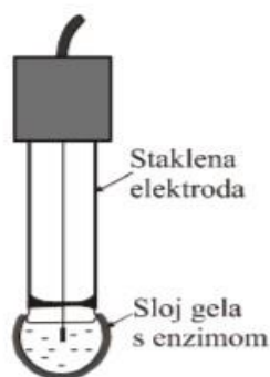
Ilustracija 4.2. Enzimska indikatorska elektroda [13]
