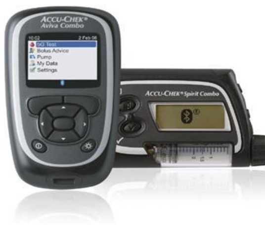
Fotografija 3.2. Sustav umjetne gušterače [4]
