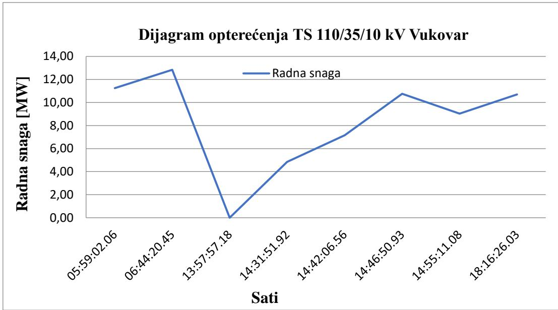
Slika 5.4. Radna snaga TS 110/35/10 kV Vukovar
