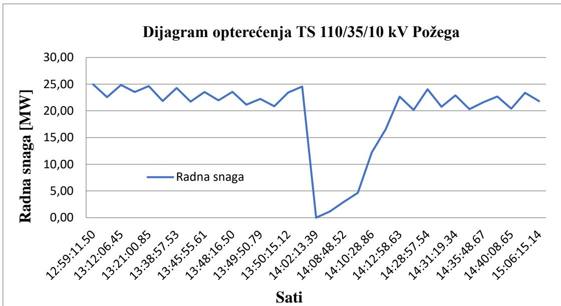
Slika 5.2. Radna snaga TS 110/35/10 kV Požega – prvi prekid
