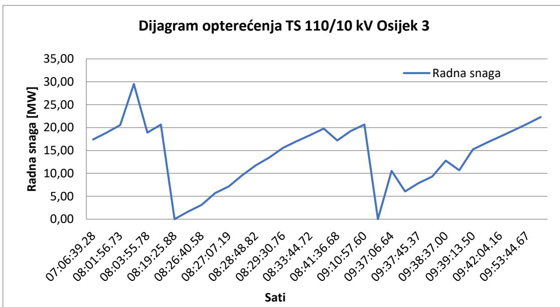
Slika 5.1. Radna snaga TS 110/10 kV Osijek 3
