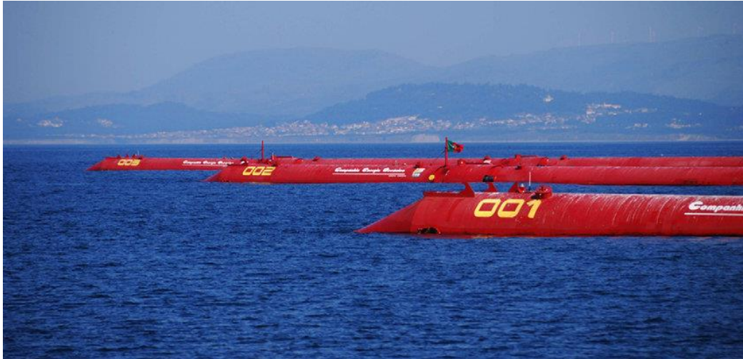
SI. 3.27. Prikaz 3 spojena Pelamis uređaja, Portugal
