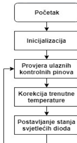
Sl. 4.11. Dijagram toka programske podrške realiziranog simulatora ventilokonvektorskog sustava.
