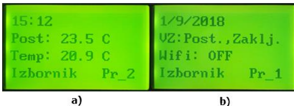
Sl. 5.6. Prikaz osnovnih informacija na GLCD zaslonu.
