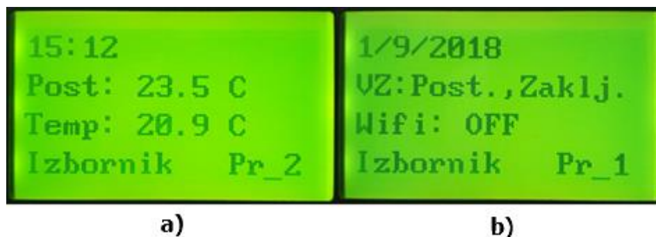
Sl. 5.6. Prikaz osnovnih informacija na GLCD zaslonu.
