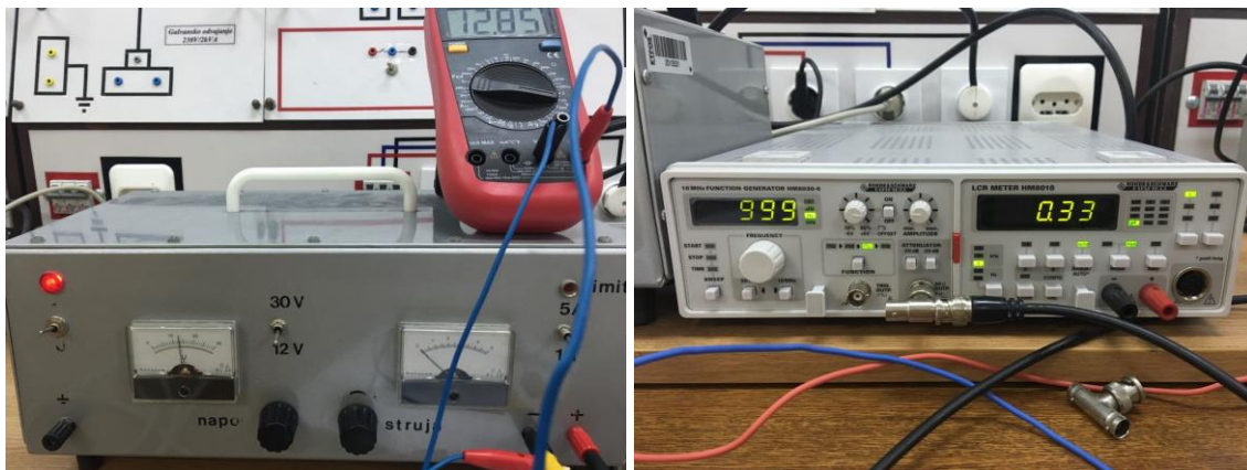
Slika 5.3 Voltmetar za kontrolu izlaza istosmjernog napajanja (lijevo). Funkcijski generator (desno).
