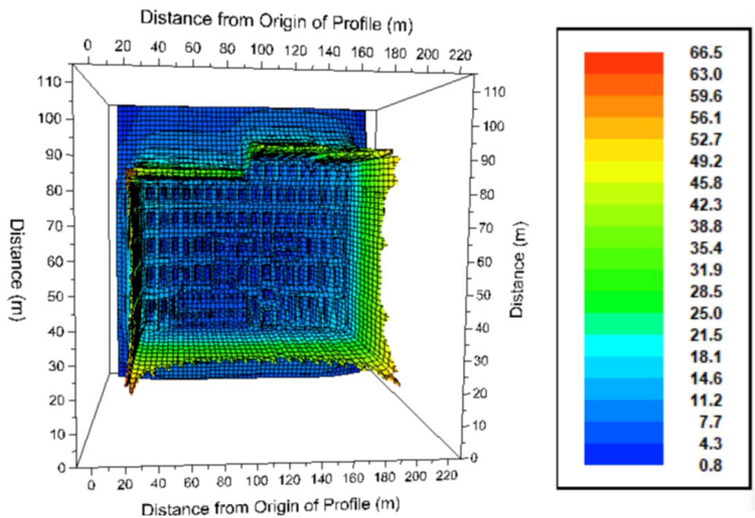
Slika 3.11. 3D prikaz napona koraka kada je ograda spojena na glavni uzemljivač za prvi slučaj
