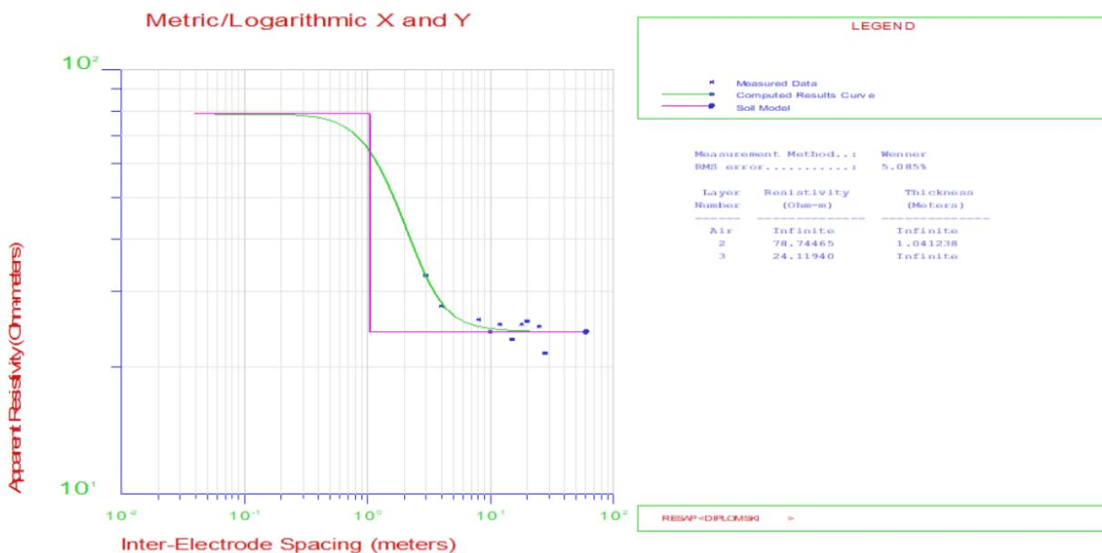
Slika 3.17. Rezultati simulacije dvoslojnog horizontalnog tla u RESAP-u
