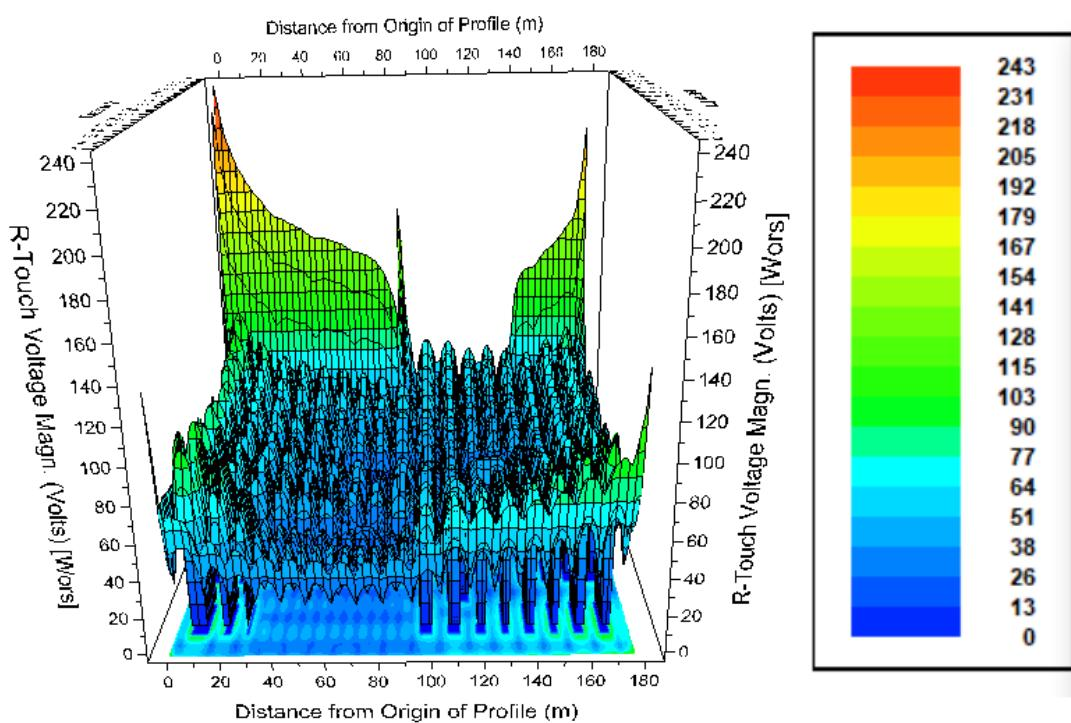
Slika 3.8. 3D prikaz napona dodira kada je ograda spojena na glavni uzemljivač za prvi slučaj (1)
