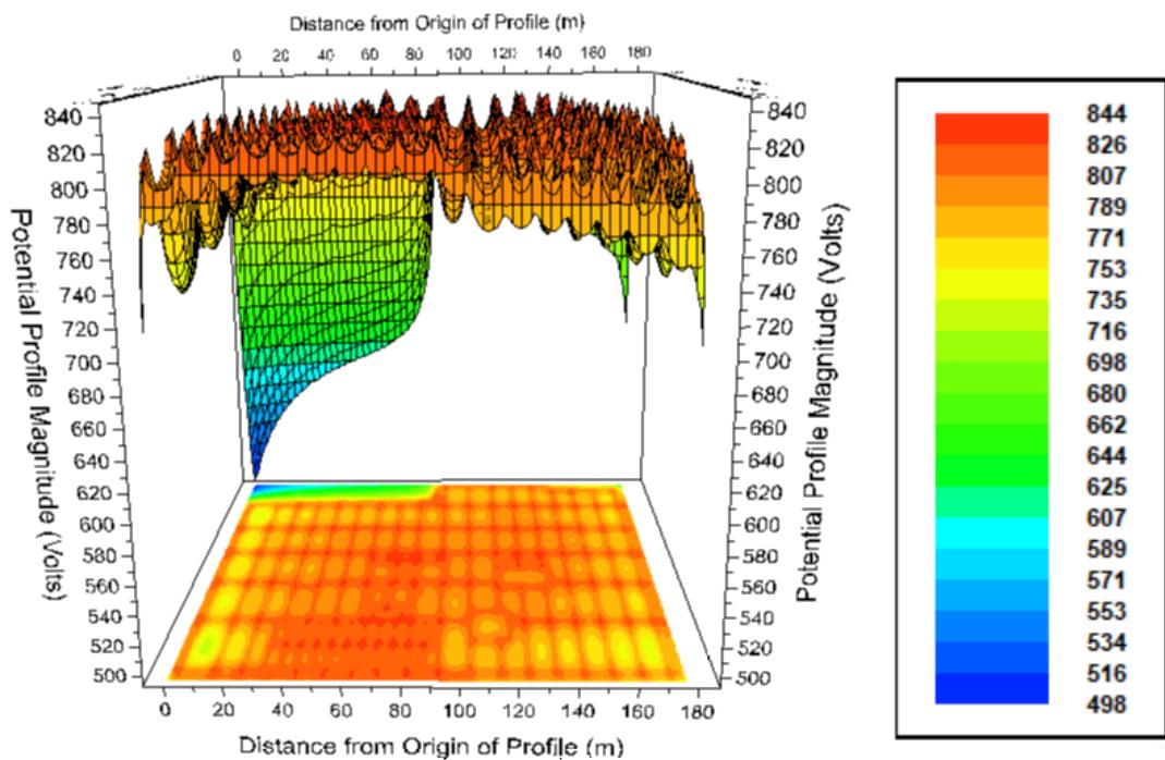
Slika 3.6. 3D prikaz potencijala zemljišta kada je ograda spojena na glavni uzemljivač za prvi slučaj (2)
