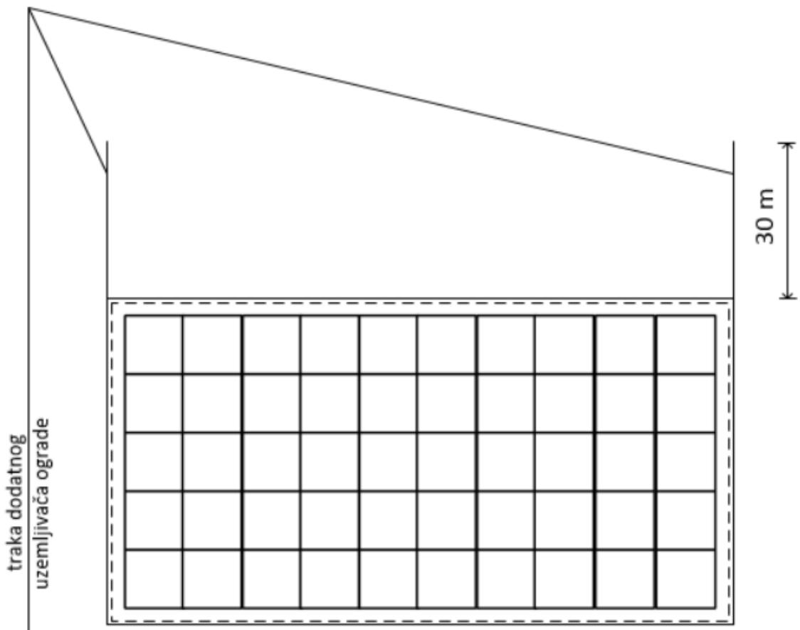
Slika 2.9. Dodatni trakasti uzemljivač za smanjenje potencijala ograde [2]
