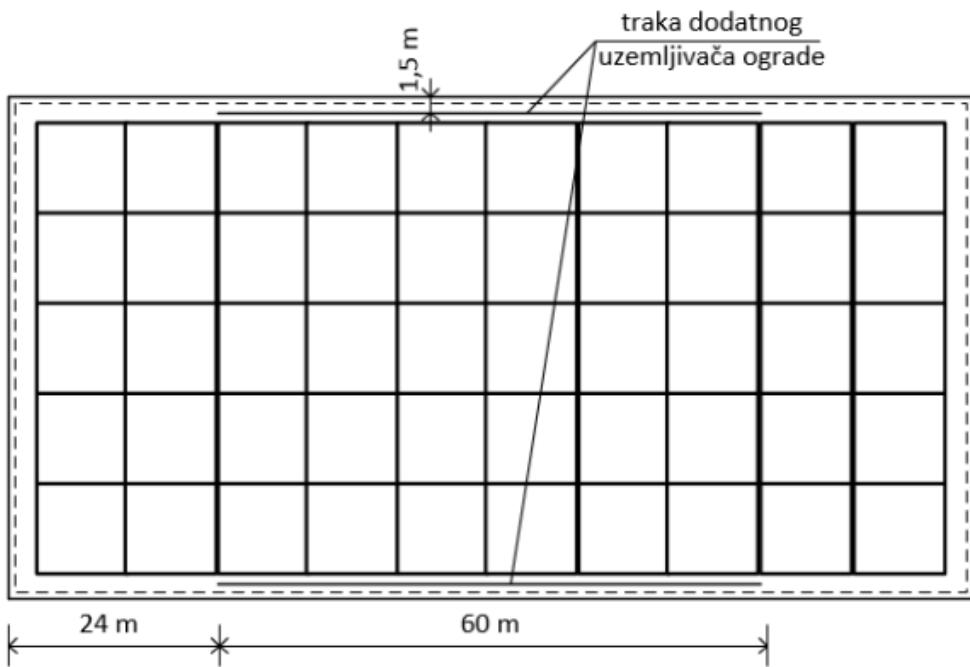
Slika 2.8. Dodatni trakasti uzemljivač za izjednačenje potencijala na srednjim dijelovima ograde [2]
