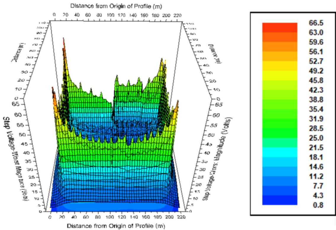
Slika 3.12. 3D prikaz napona koraka kada je ograda spojena na glavni uzemljivač za prvi slučaj
