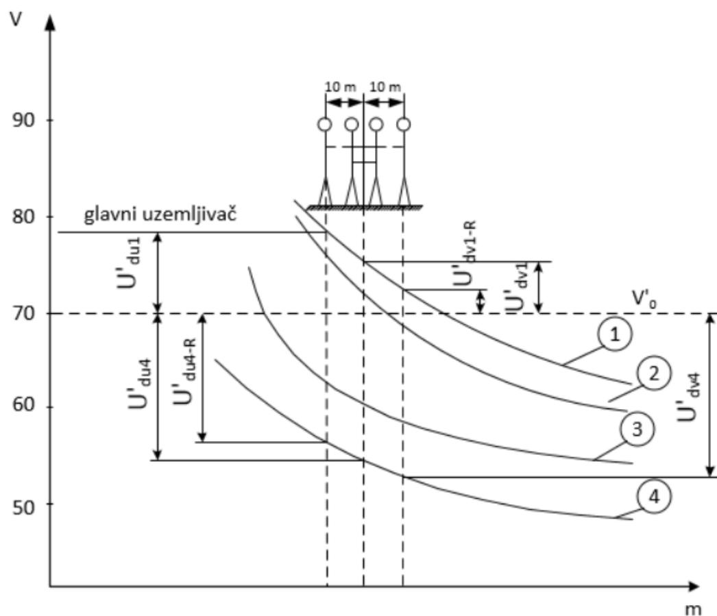
Slika 2.4. Raspodjela potencijala i naponi dodira za četiri odabrana pravca na duljini od 20 m kada ograda nije uzemljena [2]
