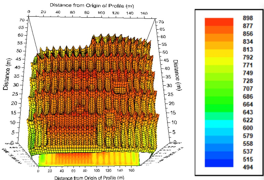
Slika 3.31. 3D prikaz potencijala zemljišta kada je ograda galvanski odvojena od glavnog uzemljivača (1)
