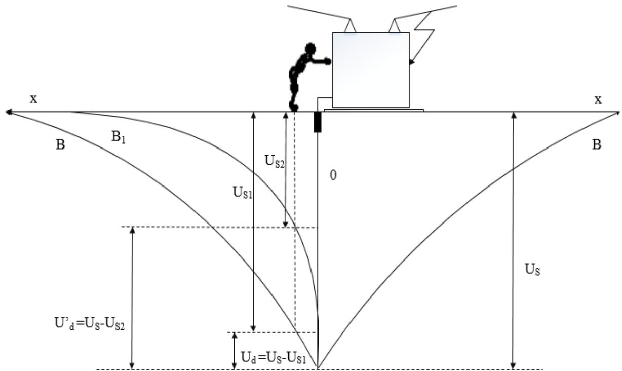
Slika 2.1. Dodirni napon i raspodjela potencijala oko uzemljivača[2]
