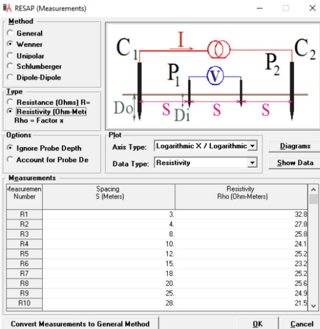
Slika 3.15. Prikaz unosa izmjerene otpornosti tla u RESAP-u
